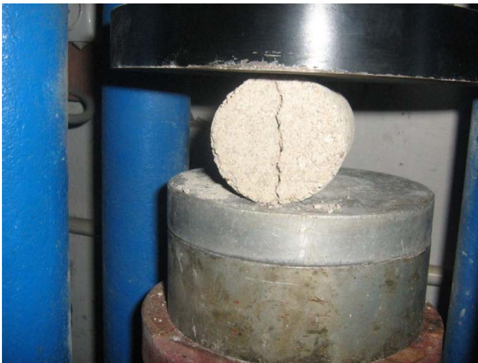
Figure 6.3 Eprouvette de tuf soumise à l'essai de traction par fendage
