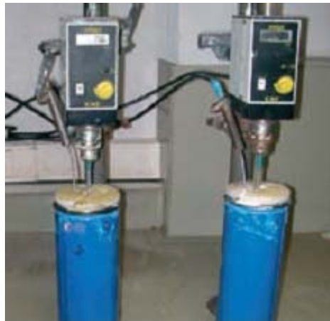
Figure 3.1 : Test de réactivité
