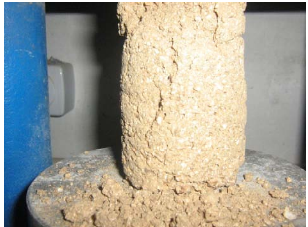
Essai de traction d'éprouvette (tuf+6% chaux) de Telghemt après 14 jours de conservation
