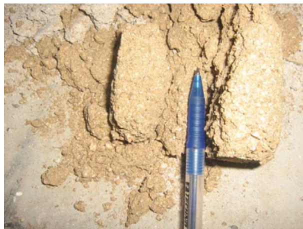
Essai de Compression d'éprouvette (tuf+0% chaux) de Draa Dissa après 7 jours de conservation
