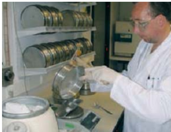
Figure 3.3 : Test de granulométrie
