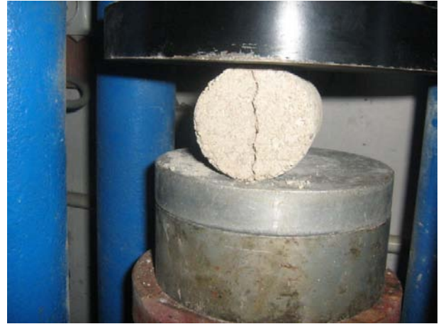
Essai de traction d'éprouvette (tuf+6% chaux) de Telghemt après 14 jours de conservation
