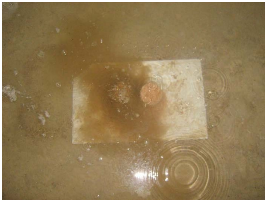
Figure 6.8 Eprouvettes en tuf de Telghemt (à droite) et de Draa Dissa (à gauche) après 65 jours de conservation.
