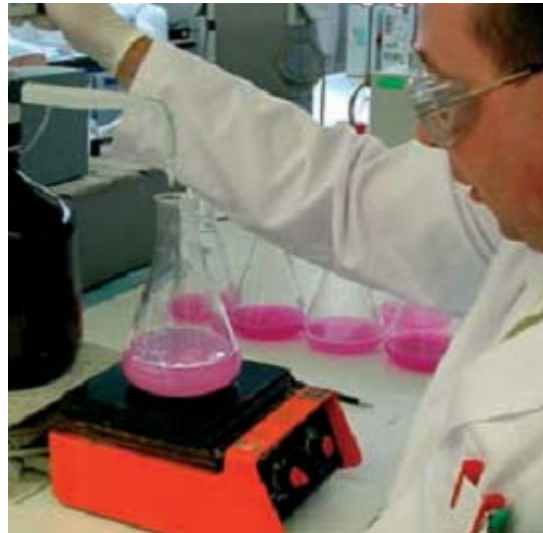
Figure 3.2 : Mesure de la chaux disponible
