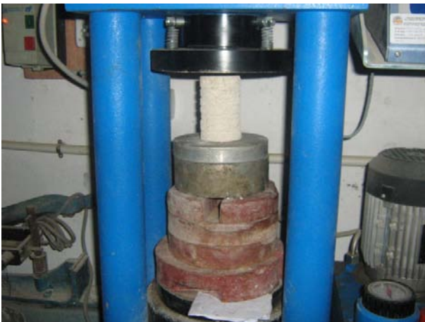
Essai de traction d'éprouvette (tuf+6% chaux) de Telghemt après 14 jours de conservation
