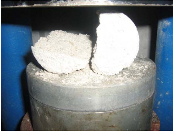
Essai de traction d'éprouvette (tuf+6% chaux) de Telghemt après 14 jours de conservation
