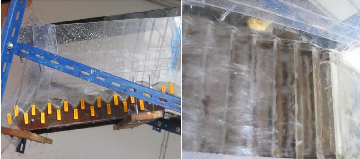
**Figure 121.** L'écoulement sur les marches d'escaliers pour  $Q_1$  à  $\alpha=0^\circ$
