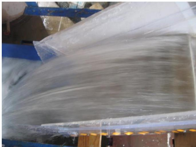
**Figure 148. L'écoulement sur les marches d'escaliers pour  $Q_3$  à  $\alpha = 5^\circ$**
