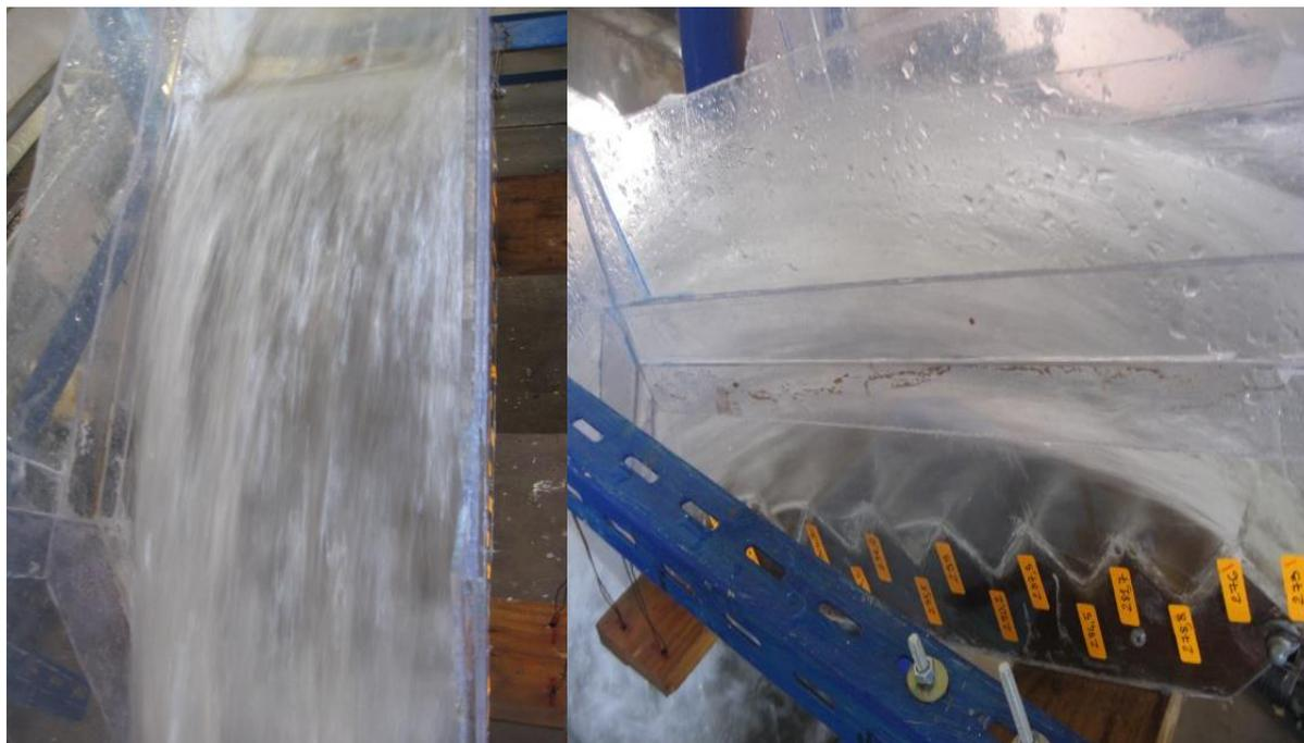
**Figure 131. L'écoulement sur les marches d'escaliers pour Q4 à  $\alpha = 5^\circ$**
