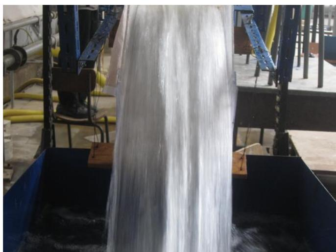
**Figure 152.** . L'écoulement sur les marches d'escaliers pour  $Q_4$  à  $\alpha = 10^\circ$
