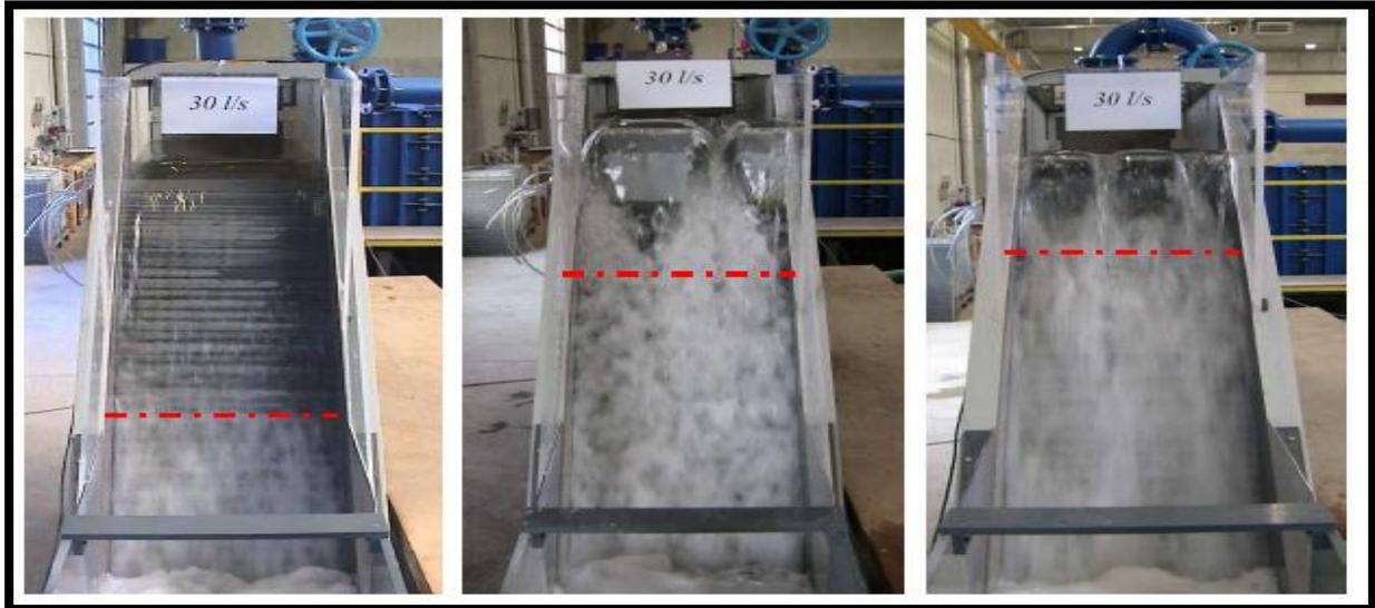
**Figure 34 .Comparaison de la position du point de début d'eau blanche (chenal aval dans sa position I, pour  $Q = 30 \text{ l/s}$ ) - gauche : seuil libre standard, centre : PKW1 et droite : PKW2.**
