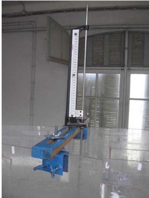
Figure 51. Photo de limnimètre
