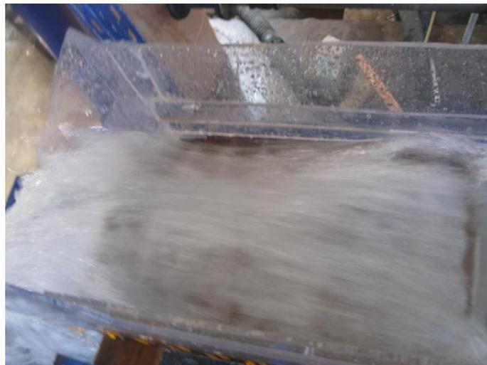
**Figure 111. L'écoulement sur les marches d'escaliers pour Q4 à  $\alpha = 5^\circ$**
