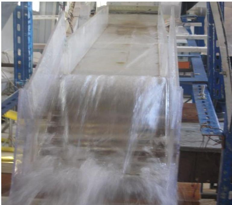
**Figure 123. L'écoulement sur les marches d'escaliers pour  $Q_1$  à  $\alpha = 10^\circ$**
