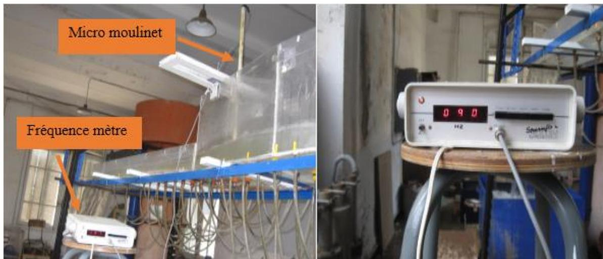
**Figure 52. Photos de dispositif de mesure de la vitesse**
