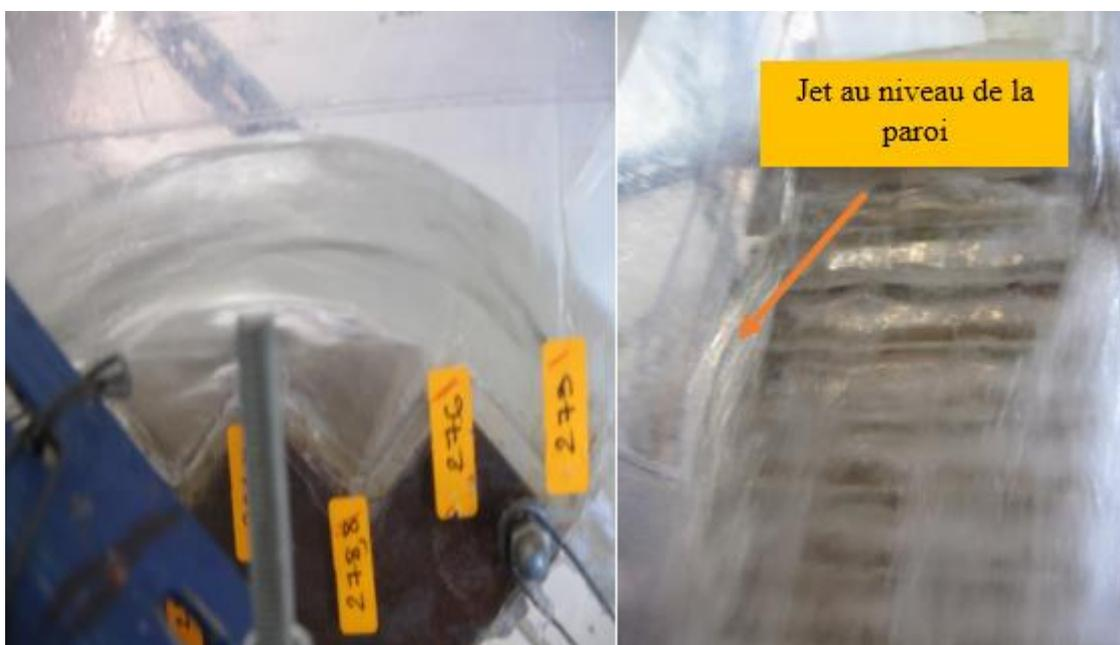
**Figure 147.**L'écoulement sur les marches d'escaliers pour  $Q_3$  à  $\alpha = 0^\circ$
