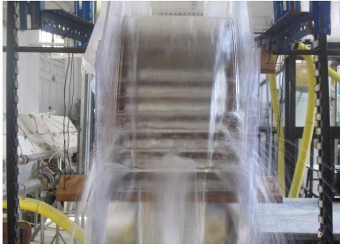
**Figure 142. L'écoulement sur les marches d'escaliers pour  $Q_1$  à  $\alpha = 5^\circ$**
