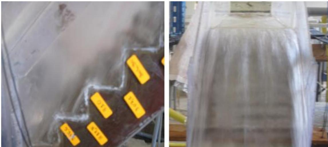
**Figure 145 .L'écoulement sur les marches d'escaliers pour  $Q_2$  à  $\alpha = 5^\circ$**
