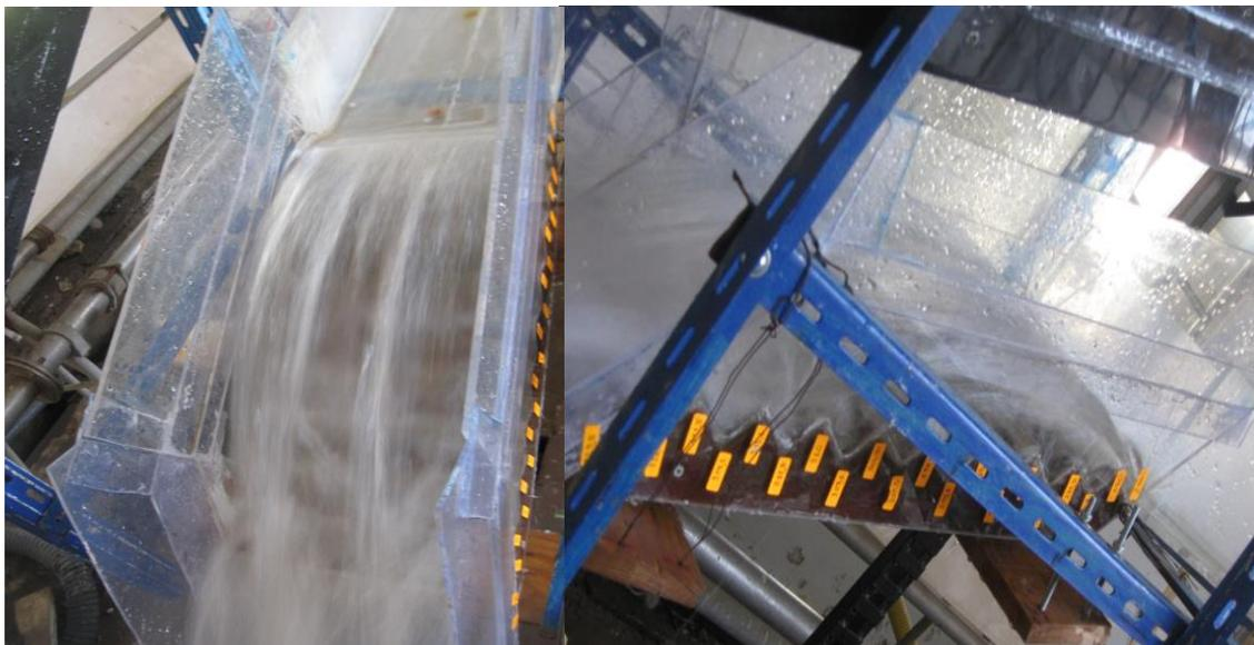
**Figure 125 .L'écoulement sur les marches d'escaliers pour Q2 à  $\alpha = 5^\circ$**
