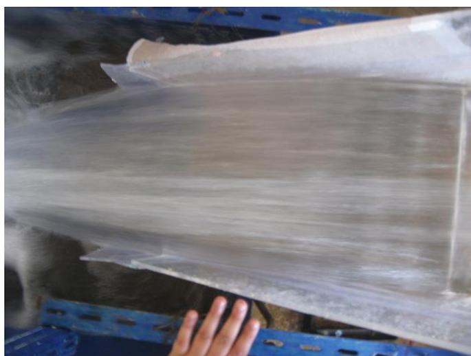
**Figure 149. L'écoulement sur les marches d'escaliers pour  $Q_3$  à  $\alpha = 10^\circ$**
