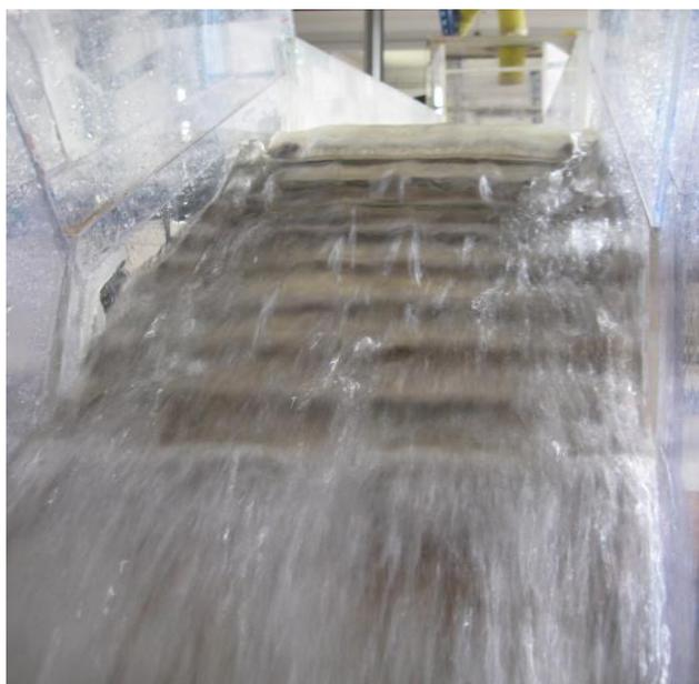
**Figure 124. L'écoulement sur les marches d'escaliers pour  $Q_2$  à  $\alpha = 0^\circ$**
