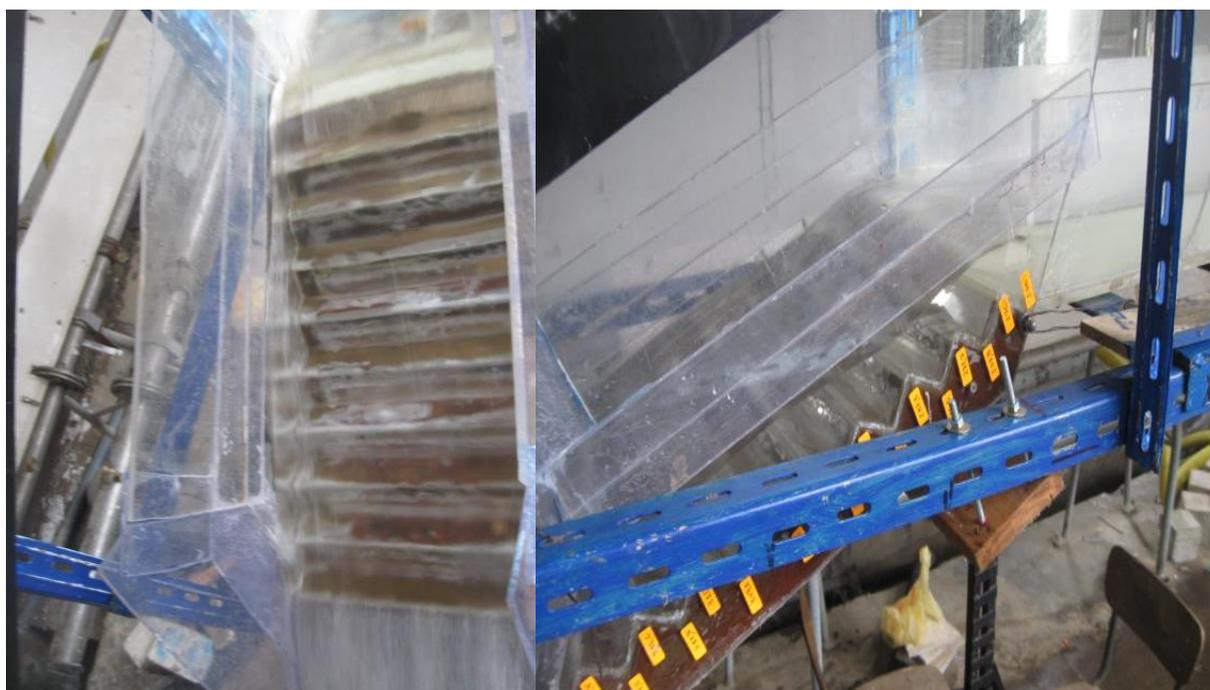
**Figure 130. L'écoulement sur les marches d'escaliers pour Q4 à  $\alpha = 0^\circ$**
