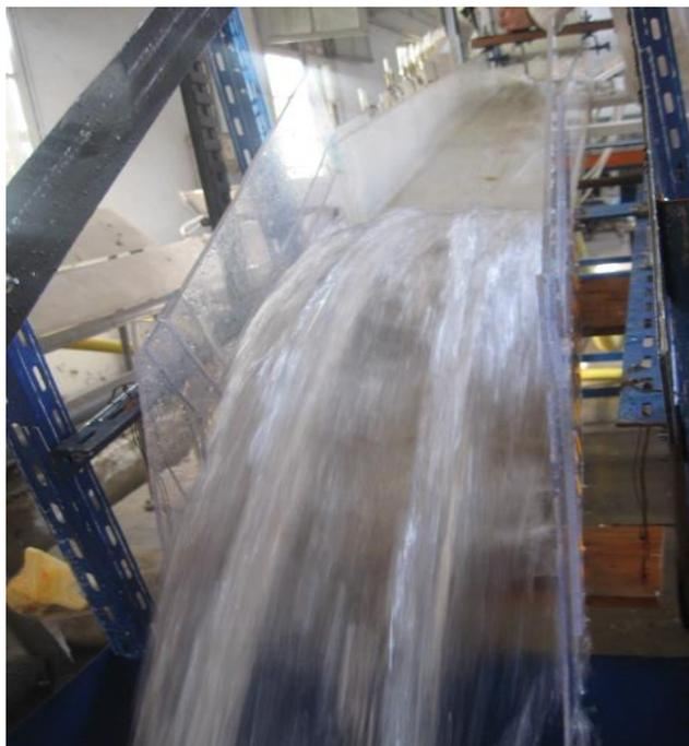
**Figure 129. L'écoulement sur les marches d'escaliers pour Q3 à  $\alpha = 10^\circ$**
