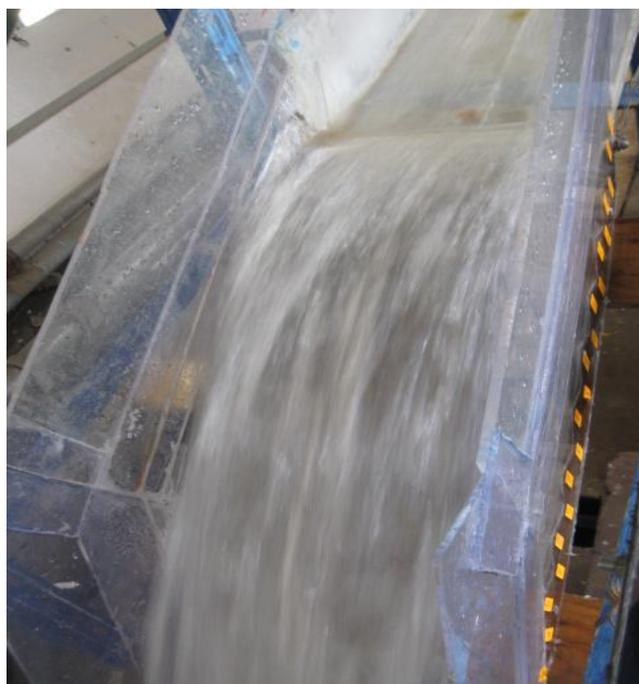
**Figure 128. L'écoulement sur les marches d'escaliers pour Q<sub>3</sub> à  $\alpha = 5^\circ$**
