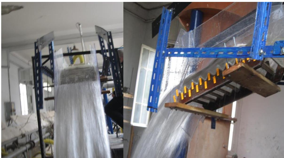
**Figure 127. L'écoulement sur les marches d'escaliers pour Q<sub>3</sub> à  $\alpha = 0^\circ$**
