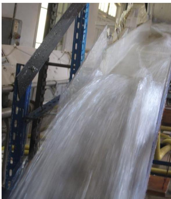
**Figure 132. L'écoulement sur les marches d'escaliers pour Q4 à  $\alpha = 10^\circ$**
