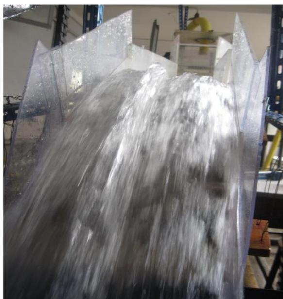
**Figure 126. L'écoulement sur les marches d'escaliers pour Q2 à  $\alpha = 10^\circ$**
