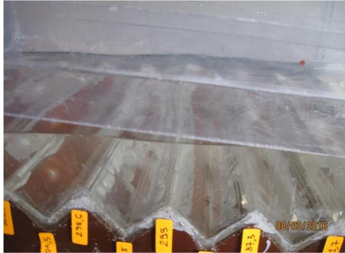
**Figure 106 . L'écoulement sur les marches d'escaliers pour Q<sub>2</sub> à  $\alpha = 0^\circ$**
