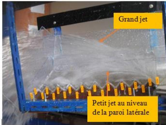
Figure 112. L'écoulement sur les marches d'escaliers pour  $Q_4$  à  $\alpha = 10^\circ$
