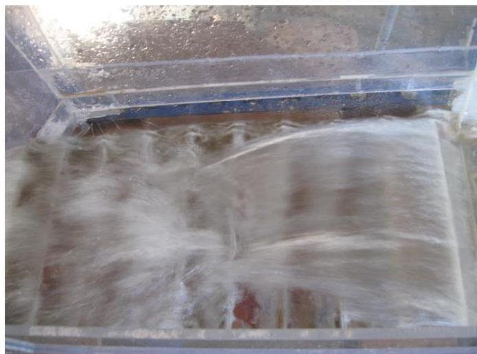
**Figure 105.** L'écoulement sur les marches d'escaliers pour  $Q_1$  à  $\alpha = 10^\circ$
