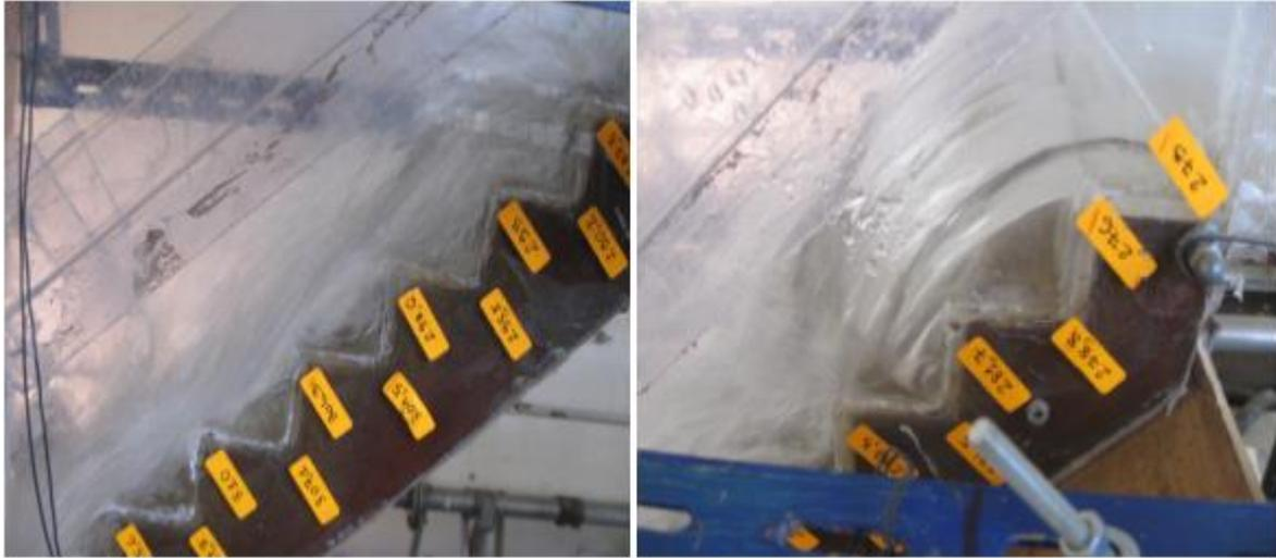
**Figure 144 . L'écoulement sur les marches d'escaliers pour  $Q_2$  à  $\alpha = 0^\circ$**
