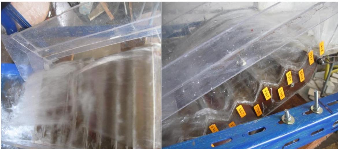
**Figure 122.** L'écoulement sur les marches d'escaliers pour  $Q_1$  à  $\alpha = 5^\circ$
