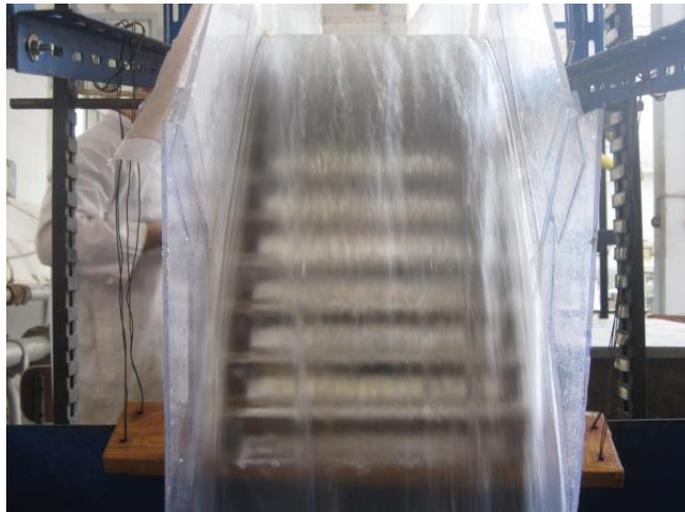
**Figure 143. L'écoulement sur les marches d'escaliers pour  $Q_1$  à  $\alpha = 10^\circ$**
