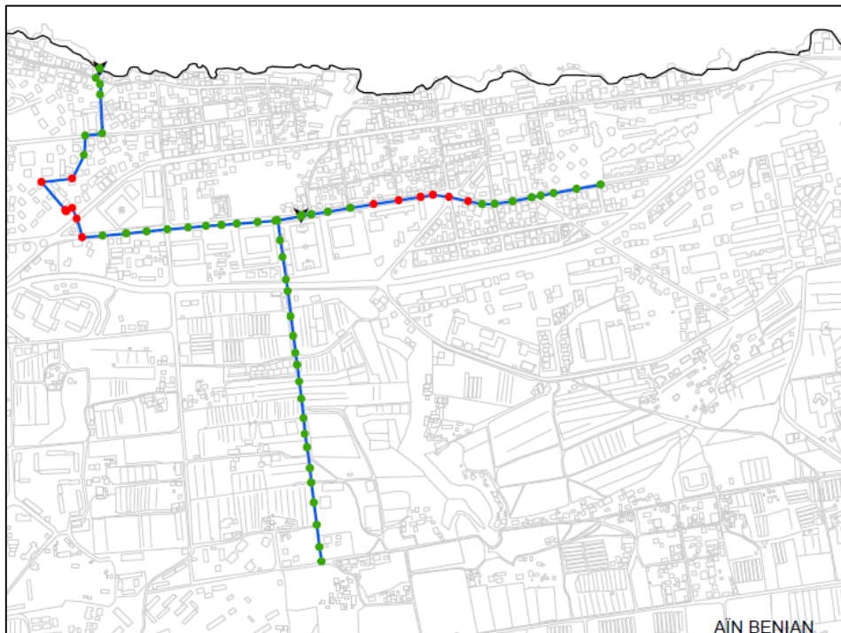
Figure IV.19. : Les nœuds à risque de débordement du collecteur de Ain Benian
