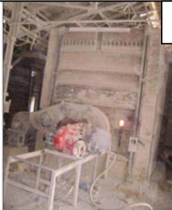
Photo III.12 : Broyeur pendulaire PM-8.5 utilisé dans l'usine
