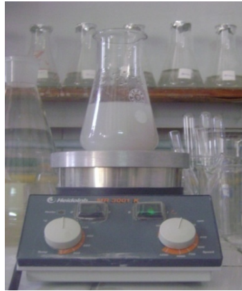
Figure V.3 : Agitation de la solution de (bentonite-solution chargée en \text{Cr}^{+3} ).
