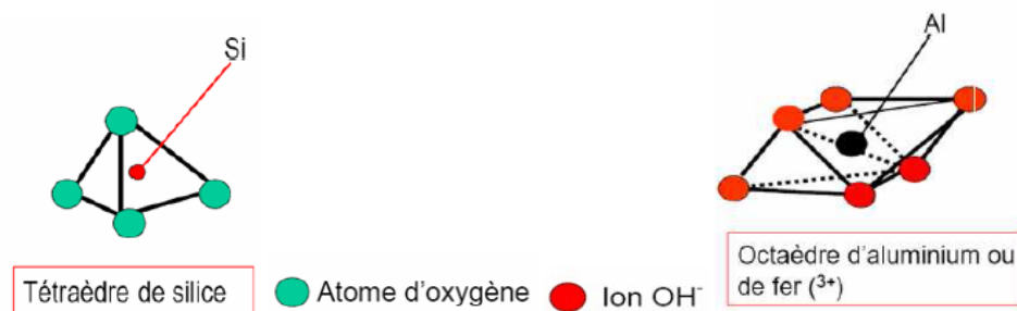
Figure I.7 : Le tétraèdre de silice et l'octaèdre d'aluminium.
