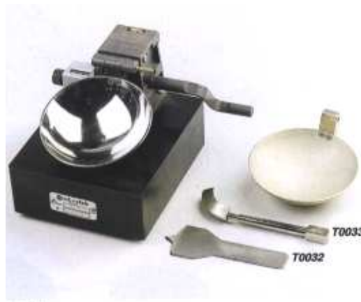
Figure III-2 : Appareil de Casagrande.
