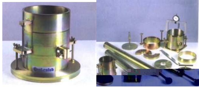
Figure III-4 : Moule et appareillage Proctor CBR.
