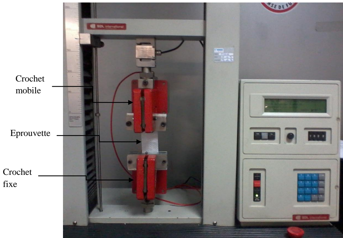
Figure IV. 5 : Emplacement de l'éprouvette entre les crochets du testomètre
