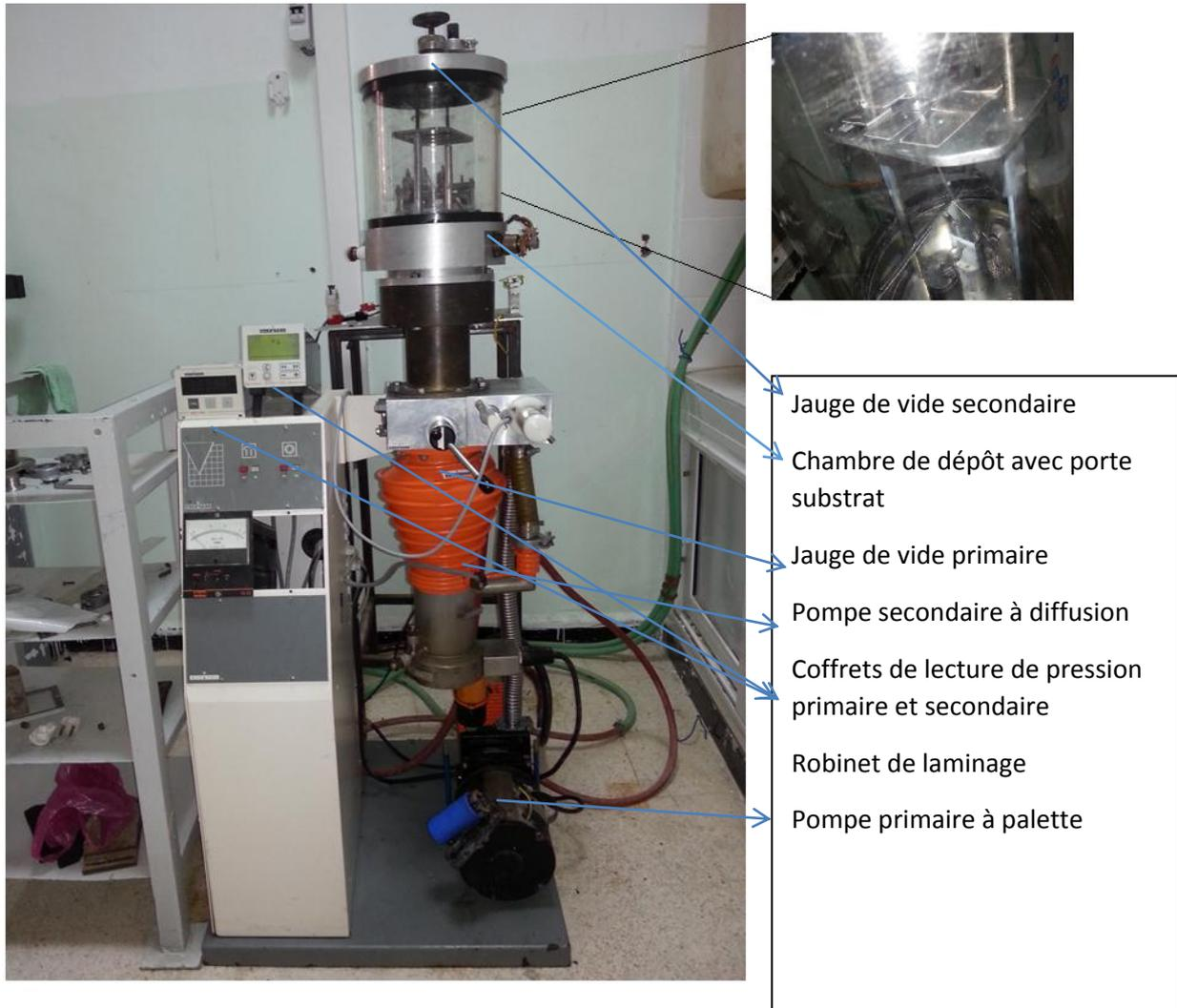
**Figure 2.2.** Appareil de dépôt de couche mince par évaporation thermique sous vide (pompe secondaire de type ALCATEL SM 60).
