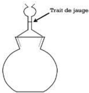
Figure 3.2 : Schéma du pycnomètre
