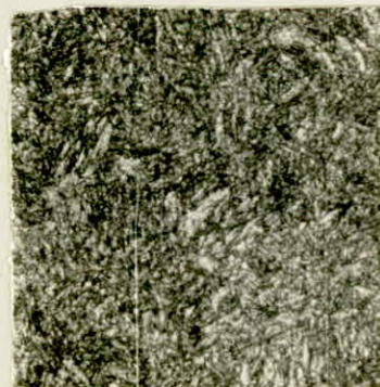
Fig. 34 Acier 35 CD4 revenu à 600°C Attaque au nital X 1000 Structure : sorbite de revenu
