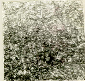
Fig. 32 Acier 35 CD4 Revenu à 500°C Attaque au nital X 1000 Structure : sorbite de revenu
