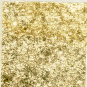
Fig. 33 Acier 45 M5 revenu à 600°C Attaque au nital X 1000 Structure : sorbite de revenu
