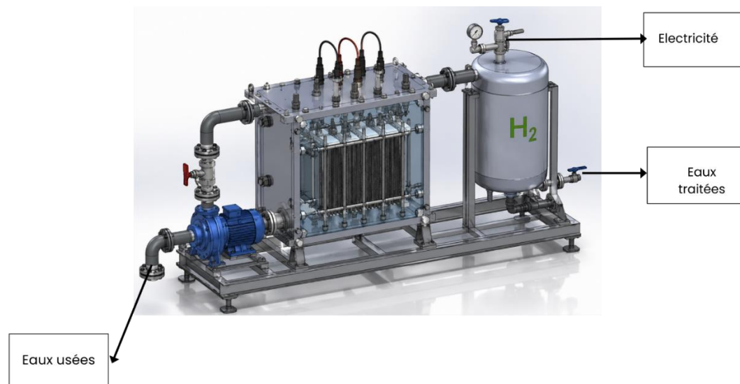
Figure 23 Prototype pilote de traitement électrochimique des effluents agroalimentaires avec récupération et stockage de l'hydrogène produit
