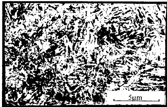
Fig. 3.14 : Micrographie du 30NC11 à l'état traité. Structure martensitique (Nital à 2% pendant 30s). Dureté= 500HV.
