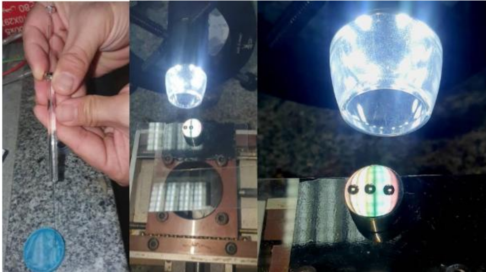
Figure II.12: Prises de vue réalisées lors de la mesure de l'angle de contact.
