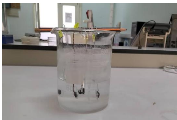
Figure II.17: échantillons immergés dans une solution de plasma sanguin artificiel pendant 14 jours.
