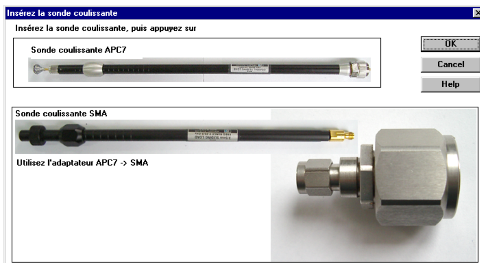
Figure A4-14 : Le logiciel demande à l'utilisateur de placer la charge coulissante
