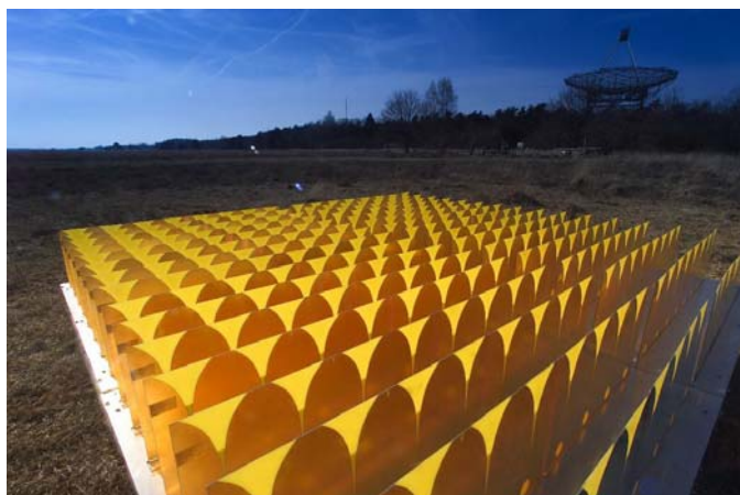
Figure 1-21 : Réseau OSMA Alignement d'antennes Vivaldi
