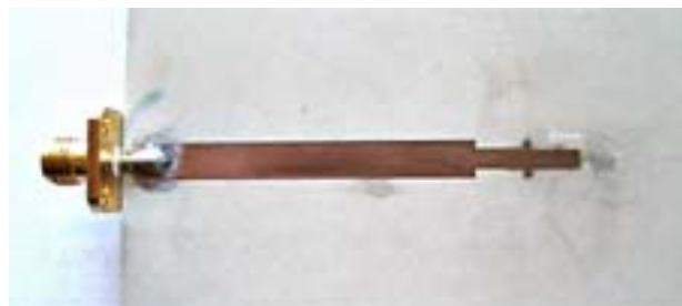
Figure 4-10 : Transition micro-ruban au revers de l'antenne
