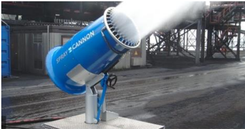
Figure 30 : Canon brumisateurs dans un chantier
