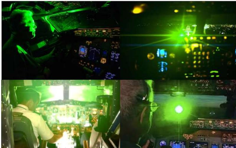
Figure 2.3 – Faisceau laser qui inonde le cockpit lors d'un vol de nuit
