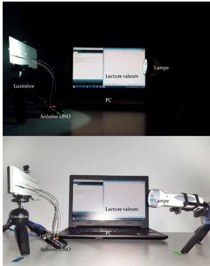
Figure 3.11 – Dispositif expérimental
