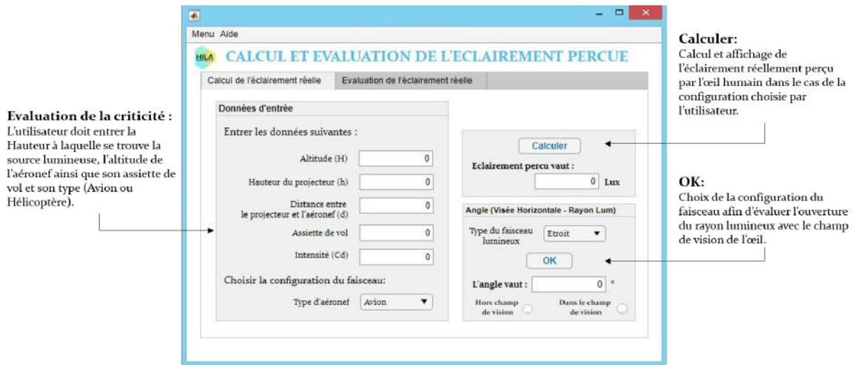
Figure R.6 – Éclairement réel
