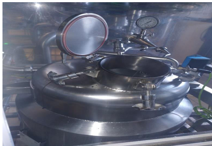
Figure 1.17: La cuve d'injection des ferments (photo réelle)
