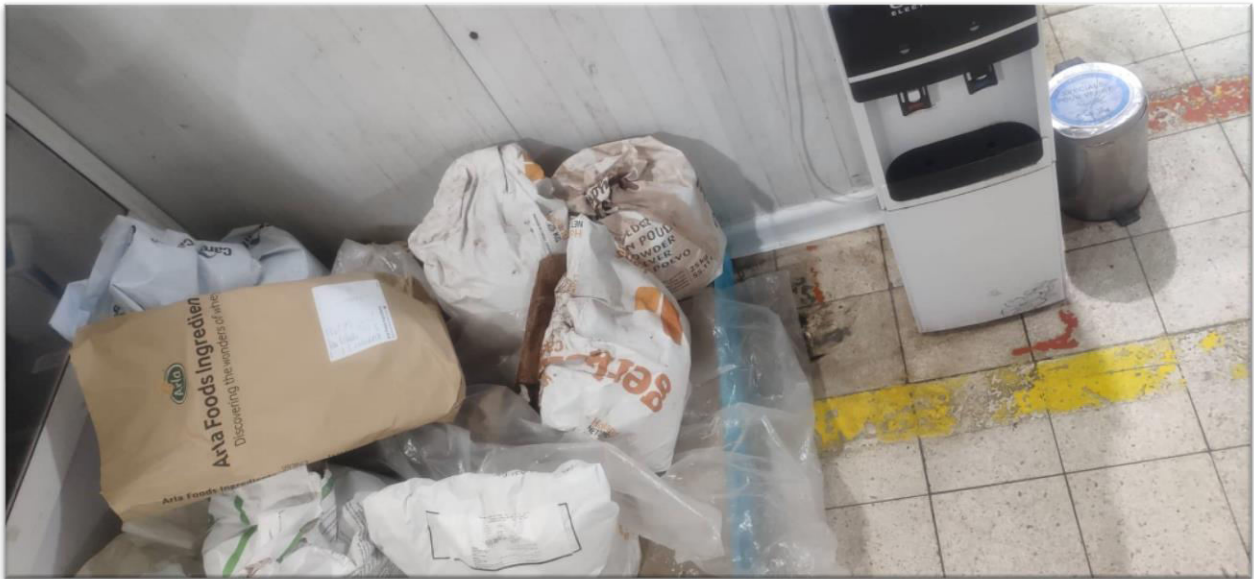
Figure 4.25: Exemple d'une zone 20 dans l'atelier de poudrage (photo réel)
