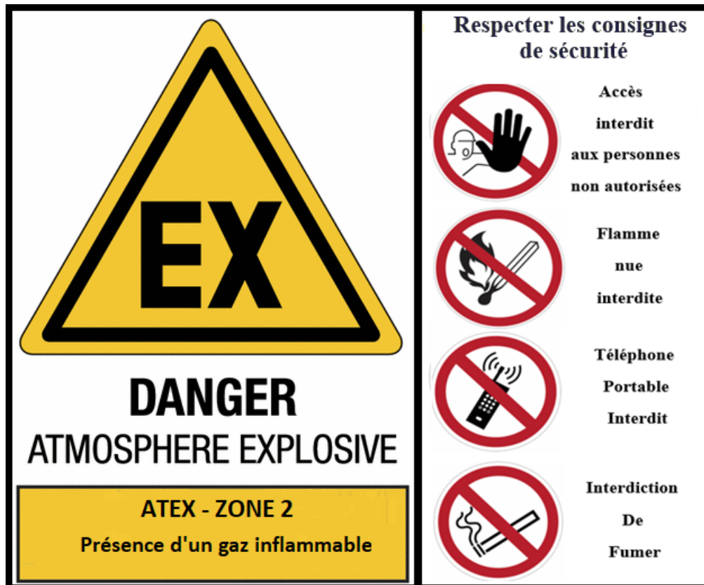
Figure 5.2 : Affichage de sécurité à l'entrée du local des chaudières
