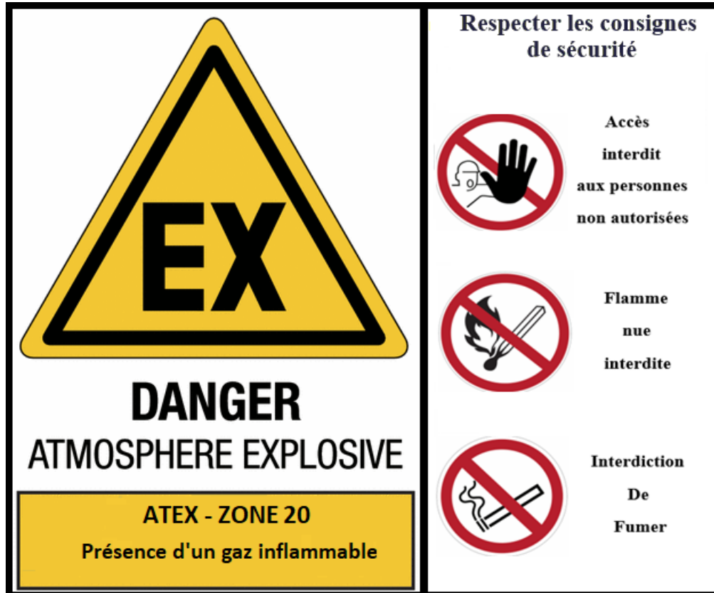
Figure 5.7 : Affichage de sécurité à l'entrée de l'atelier de poudrage
