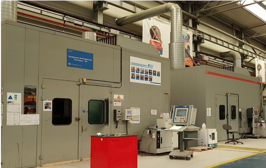
Figure 1.6. Cabines de revêtement thermique
