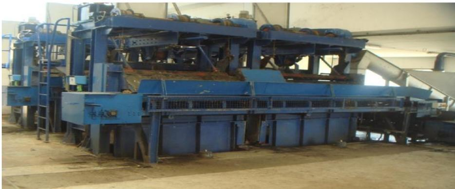
Figure 1-6: Dégrilleurs mécaniques fin et grossier [8]
