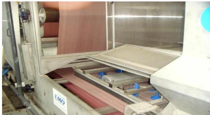
Figure 1-14: Déshydratation Mécanique par filtre à bande [8].
