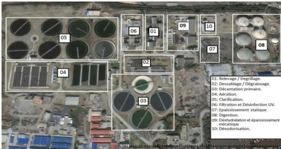
Figure 1-5: Vue aérienne des ouvrages de la station d'épuration [7].
