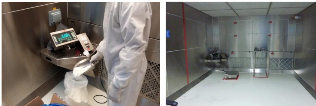
Figure I 5 : Cabine de pesée des particules solides
