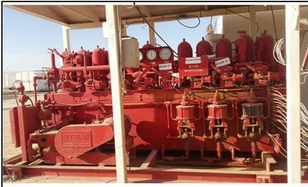
**Figure 1.4 : Unité de commande du système de contrôle du puits**
