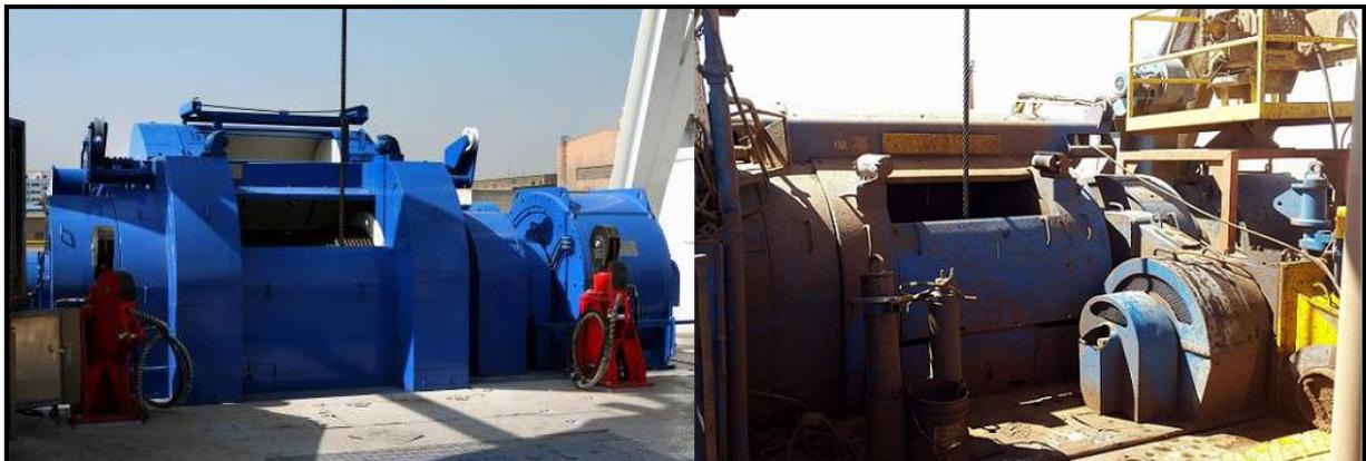
**Figure 1.5 : Système de levage (treuil)**
