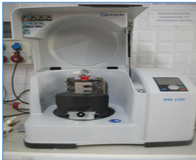
Figure 22: Broyeur planétaire à billes utilisé pour le broyage
