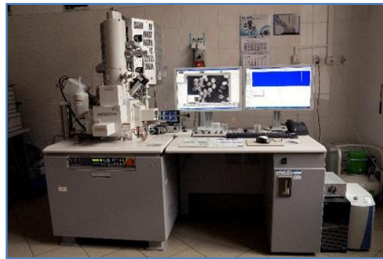
Figure 30 :EDS (UHR FE-SEM Hitachi SU 8010)
