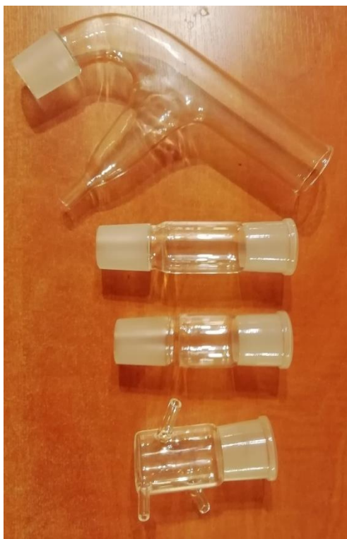
Figure 61: Tube Hallimond - les différentes parties du tube et la méthode d'utilisation au laboratoire
