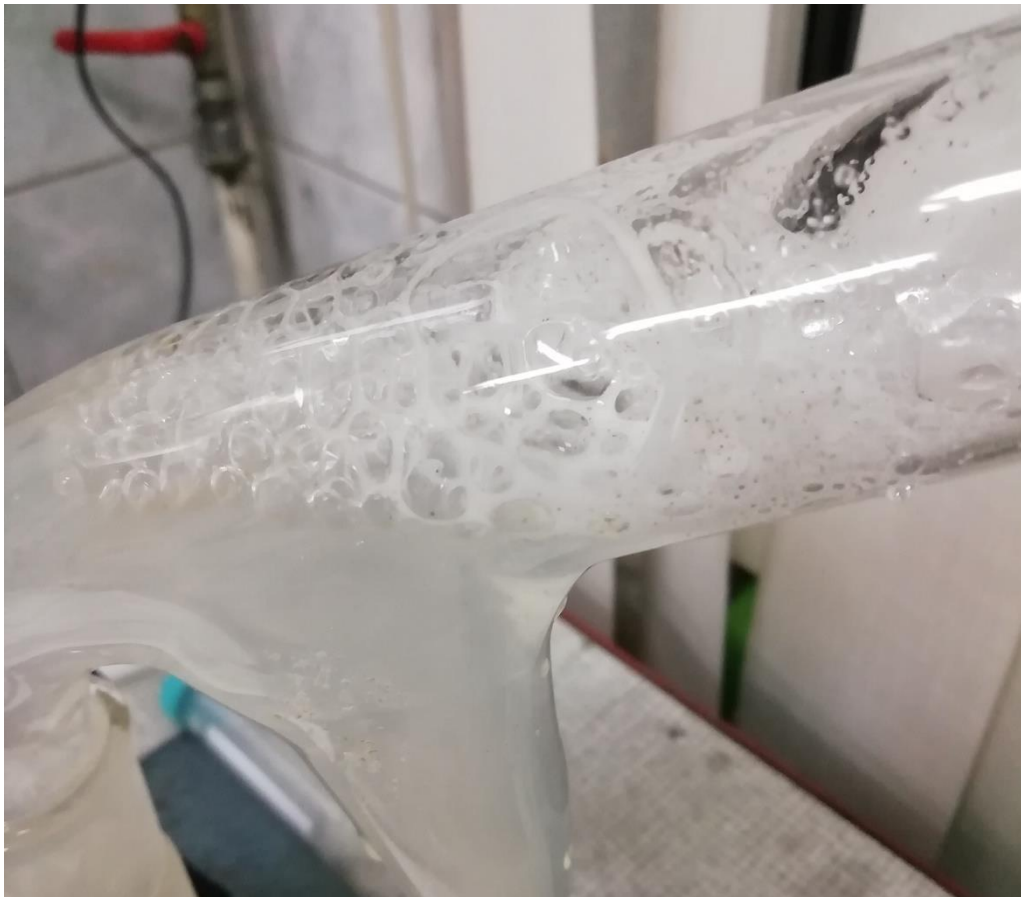
Figure 62 : Tube Hallimond - la formation de mousse pendant la flottation a été visualisée
