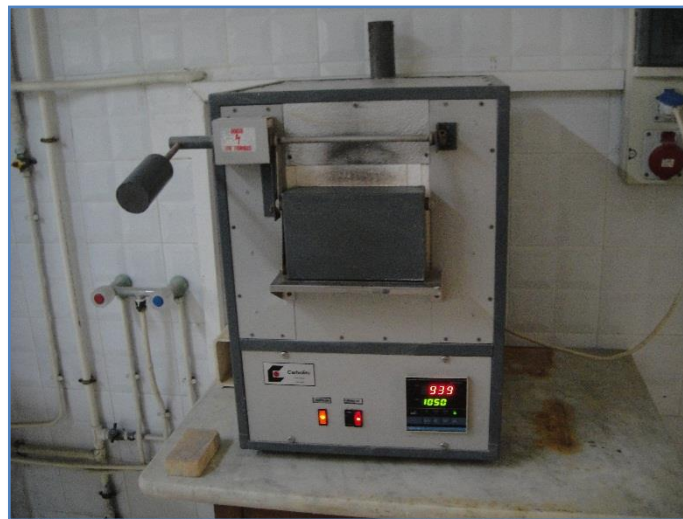
Figure 40: Four de type Carbolite utilisé pour les essais de la calcination
