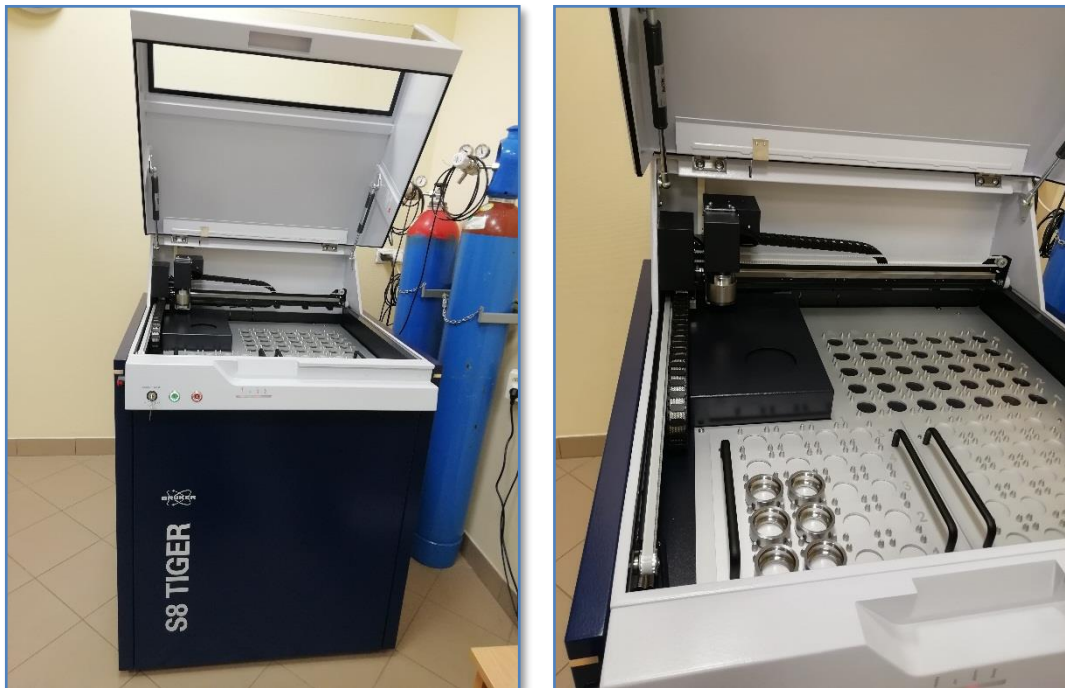
Figure 32: Diffractomètre des rayons fluorescence S8 TIGER
