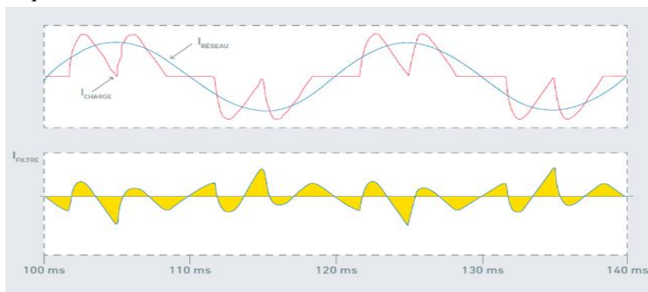
Figure 5.13 Principe de fonctionnement d'un filtre actif parallèle
