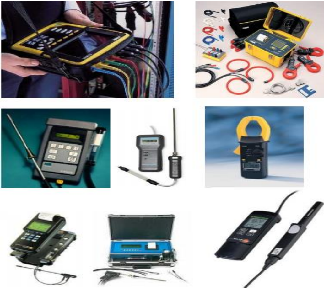
Figure 4.2 Instruments portables de base, nécessaires pour effectuer un audit énergétique [35]
