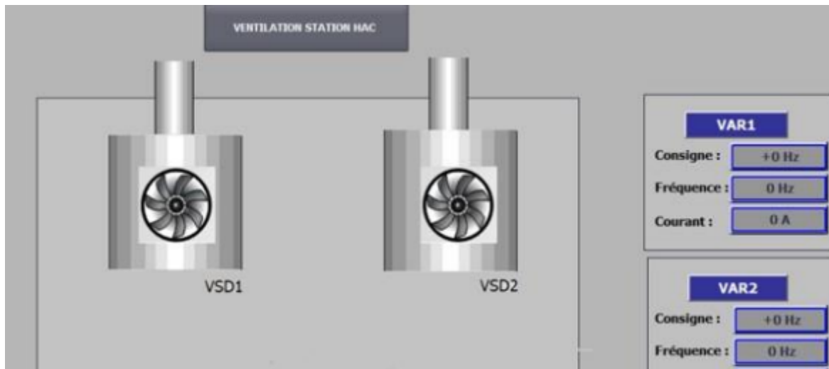
FIGURE V.6 – Ventilateurs en Arrêt.
