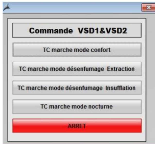
FIGURE IV.14 – Faceplate de commande ventilateur.
