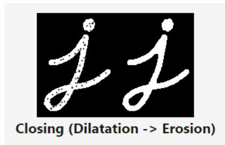
Figure 70: Application du filtre de la fermeture pour la suppression du bruit.
