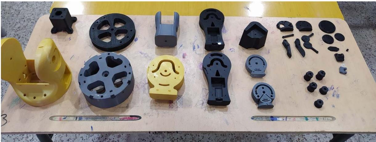
Figure 90 : les pièces imprimés par l'imprimante 3D.
