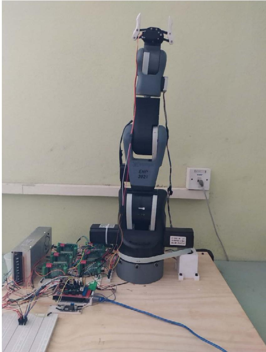
*Figure 92: l'assemblage mécanique de toutes les articulations ensemble.*
