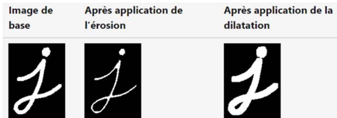
Figure 68: Résultat de l'érosion et la dilatation d'une image.
