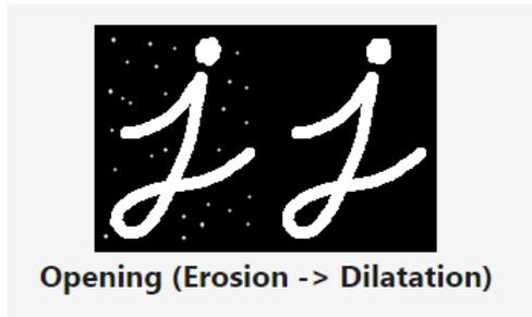
Figure 69: Application du filtre de l'ouverture pour la suppression du bruit.
