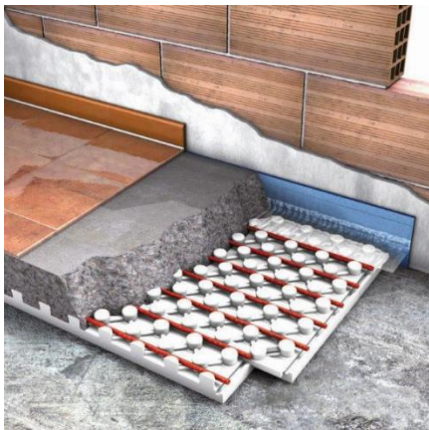
Figure 1.3 : les différents éléments d'un plancher chauffant
