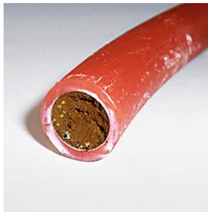
Figure 1.6: formation de boue dans un tube en Polyéthylène.
