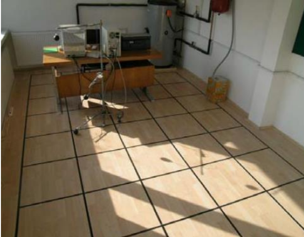
Figure 3.10: Illustration de la distribution du flux solaire sur une partie de la surface du plancher
