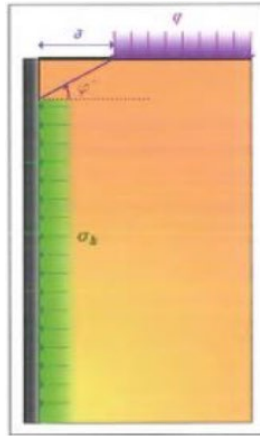
Figure II.4 : Prise en compte de l'effet de la surcharge sur l'écran
