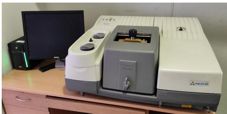
Figure III.7 : Spectroscopie infrarouge à transformée de Fourier, FTIR/ATR FTIR Thermo Nicolet NEXUS 670.
