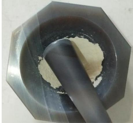
Figure III.18 : Broyage de la poudre calcinée dans un mortier.
