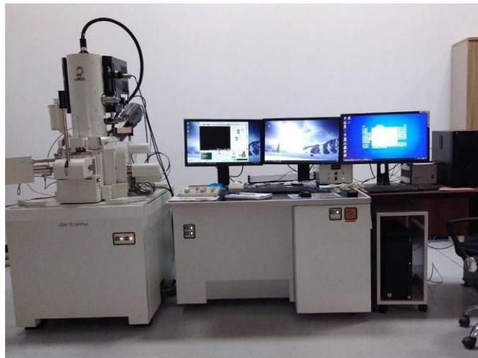
Figure III.5 : Microscope électronique à balayage Microscope Electronique à Balayage de haute résolution, JSM-7610F Plus.
