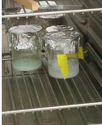
Figure III.16 : Séchage des gels dans l'étuve.
