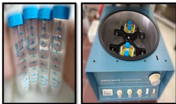
FIGURE 3.2 : Lavage de l'hydrogel par centrifugation.
