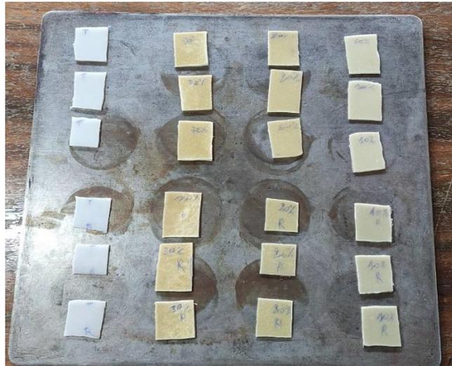
Figure II.18 : Les échantillons soumis au test de vieillissement pour les différents taux de charge.
