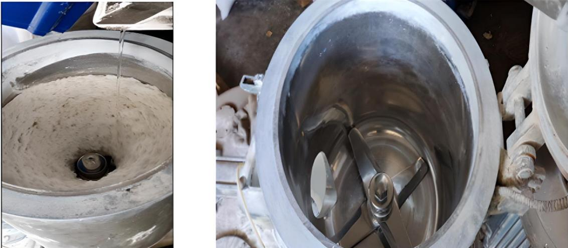
Figure II.3 : Mélangeur à cylindre (DRY BLEND).
