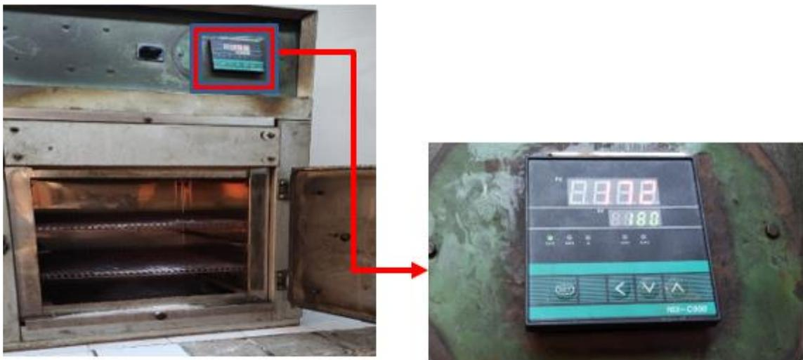
Figure II.19 : Etuve utilisée dans le test de vieillissement thermique.
