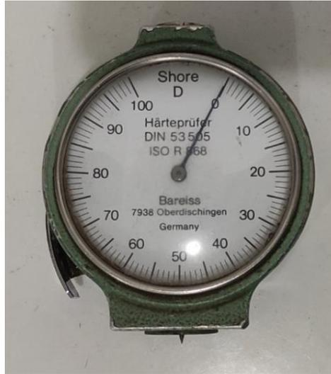
**Figure II.14 : Duromètre shore D.**
