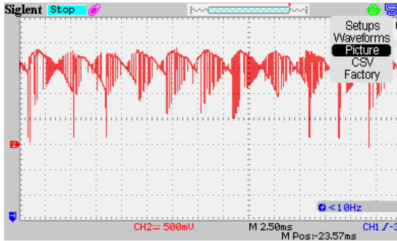
Figure 44-3 : La tension du bus continu.
