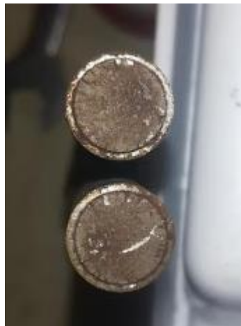
Photo 3. 14: observation de la rupture de l'éprouvette en fatigue double entaille X=10 / N°3
