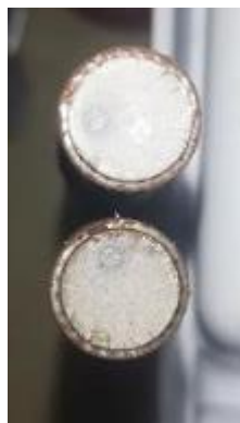
Photo 3. 22: observation de la rupture en fatigue de l'éprouvette double entaille X= 35 / N°2
