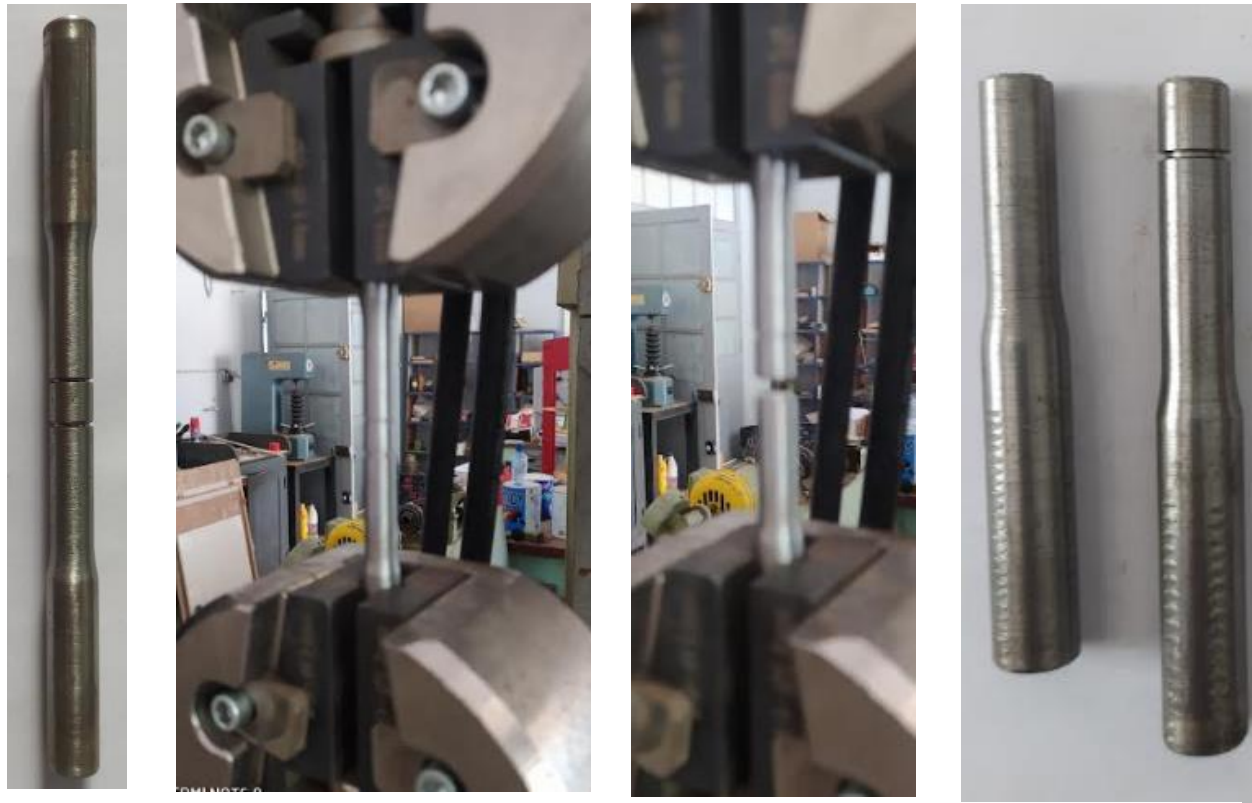
Photo 3. 3: éprouvette avec double entaille avant et après la traction
