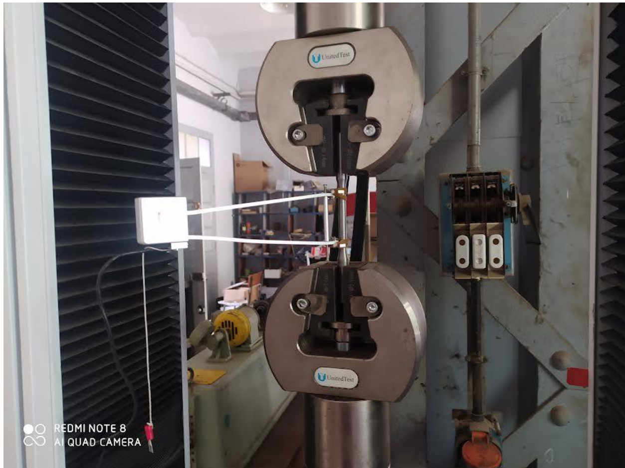
Photo 3. 1: éprouvette lisse en cour de traction
