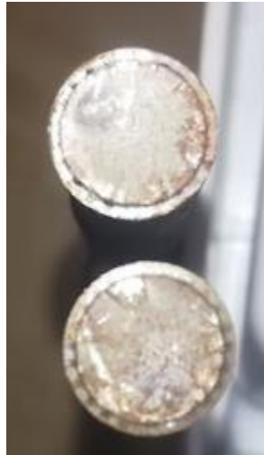
Photo 3. 23: observation de la rupture en fatigue de l'éprouvette double entaille X= 35 / N°3
