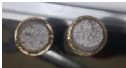
Photo 3. 8: observation de la rupture en traction de l'éprouvette double entaille X= 20 / N°3
