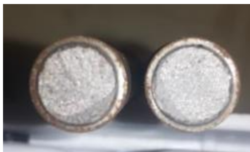
Photo 3. 11: observation de la rupture en traction de l'éprouvette double entaille X= 35 / N°1
