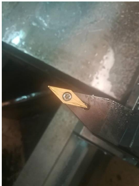
Photo 2. 2:Outil pour l'usinage des entailles.
