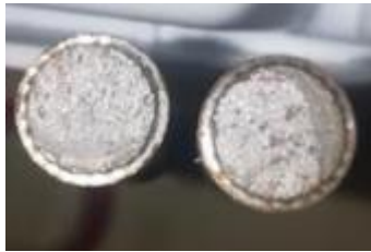
Photo 3. 5 : observation de la rupture en traction de l'éprouvette double entaille X= 10 / N°1
