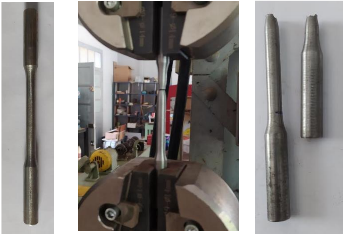
Photo 3. 2: éprouvette lisse avant et après l'essai de traction
