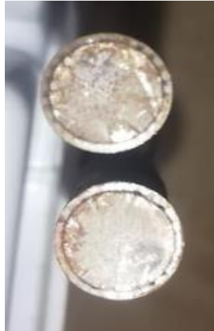
Photo 3. 19: observation de la rupture en fatigue de l'éprouvette double entaille X= 25 / N°1
