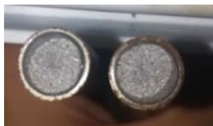
Photo 3. 9: observation de la rupture en traction de l'éprouvette double entaille X= 25 / N°2
