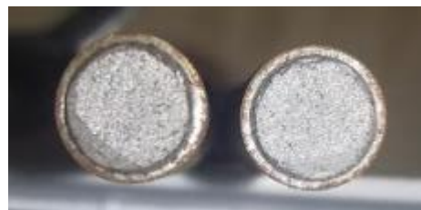
Photo 3. 10: observation de la rupture en traction de l'éprouvette double entaille X= 30 / N°1
