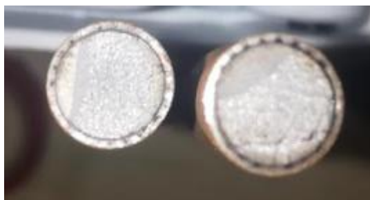
Photo 3. 12: observation de la rupture en traction de l'éprouvette double entaille X= 40 / N°1
