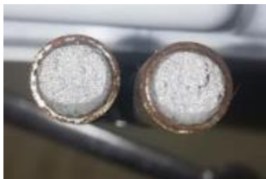
Photo 3. 7: observation de la rupture en traction de l'éprouvette double entaille X= 15 / N°3
