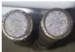
Photo 3. 6: observation de la rupture en traction de l'éprouvette double entaille X= 10 / N°2
