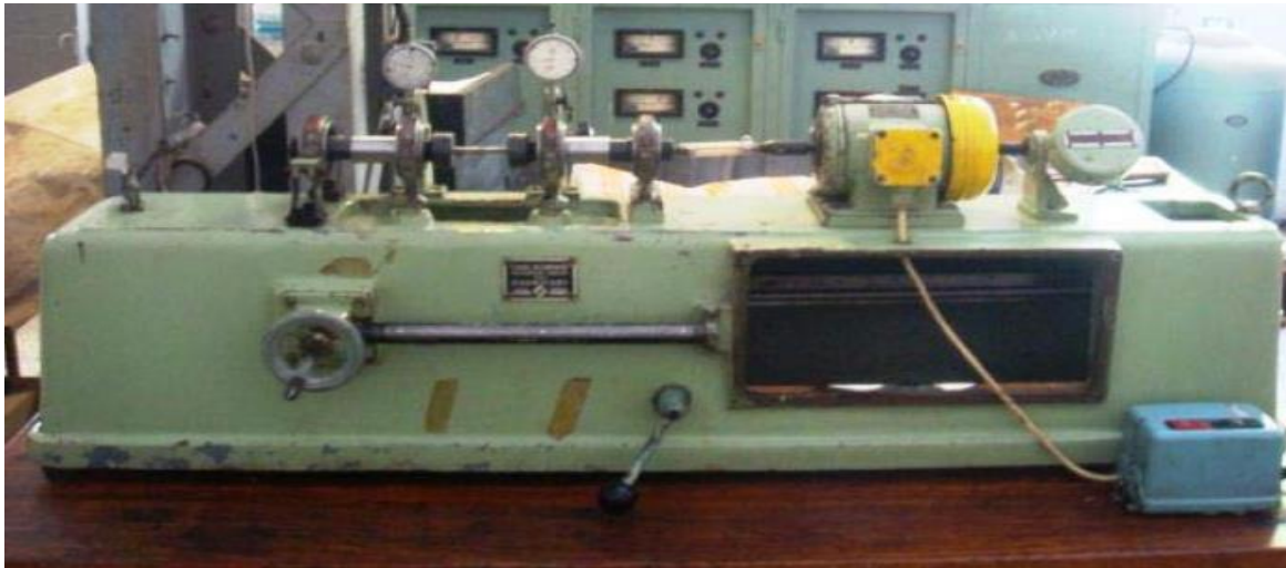
Photo 2. 3: Machine de flexion rotative « SCHENCK »
