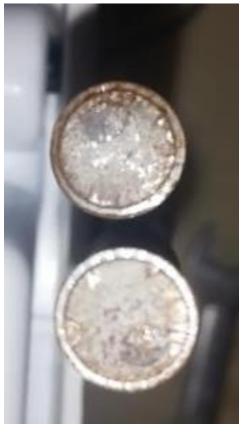
Photo 3. 16: observation de la rupture en fatigue de l'éprouvette double entaille X= 15 / N°2
