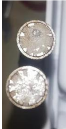
Photo 3. 21: observation de la rupture en fatigue de l'éprouvette double entaille X= 30 / N°3
