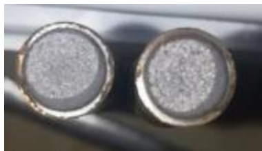
Photo 3. 13: observation de la rupture en traction de l'éprouvette double entaille X= 40 / N°2
