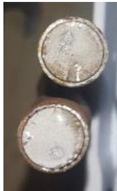
Photo 3. 24 : observation de la rupture en fatigue de l'éprouvette double entaille X= 40 / N°3
