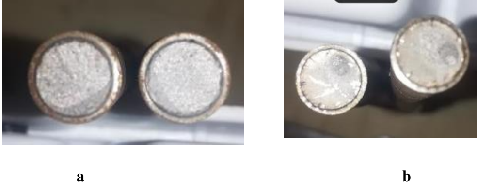
Photo 3. 4: : observation sur les ruptures des éprouvettes
