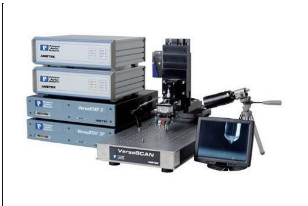
Figure. II.14 : Schéma de l'appareillage utilisé dans les des mesures électrochimiques locales (CRTI).
