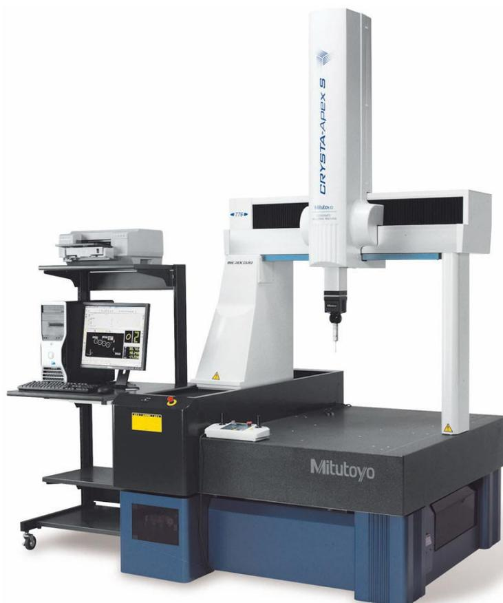
Figure 2.22 Machine de Mesure Tridimensionnelle
