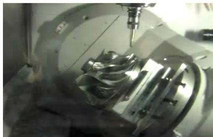
Figure 1.2 Usinage 5 axes de surface gauche
