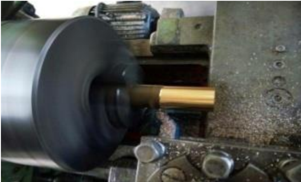
Figure III.2 Préparation l'éprouvette de l'essai de traction.
