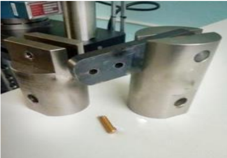
Figure III.9 Dispositif pour l'essai de cisaillement.
