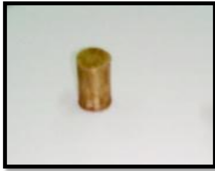
Figure III.5 Eprouvette finie pour de la micro dureté.
