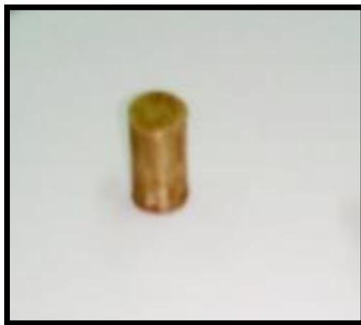
Figure III.4 Epreuve finie pour de cisaillement
