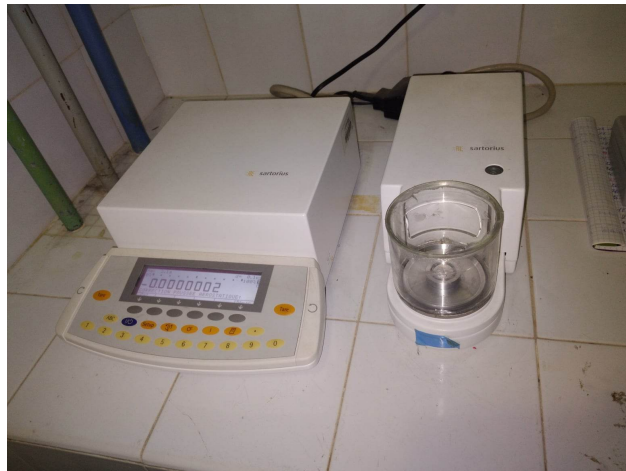
FIGURE 3.6 : Microbalance Sartorius utilisée.
