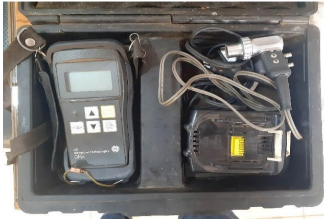
Figure III.4 : Appareil de mesures d'épaisseur
