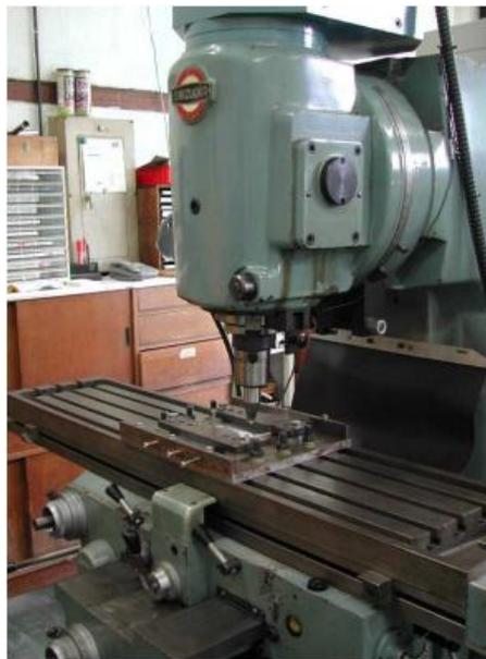
FIGURE 1.18 – Fraiseuse spécialement modifié pour le FSW
