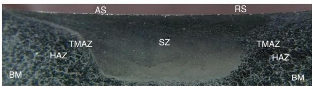
FIGURE 1.10 – Micrographie montre les quatre zone [11]
