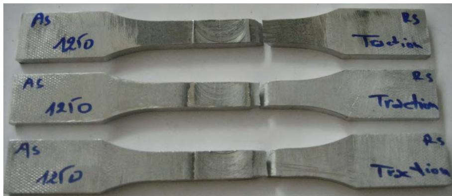
FIGURE 3.11 – Caractérisation des zones de rupture des joints soudés par FSW soumis à une charge de traction.
