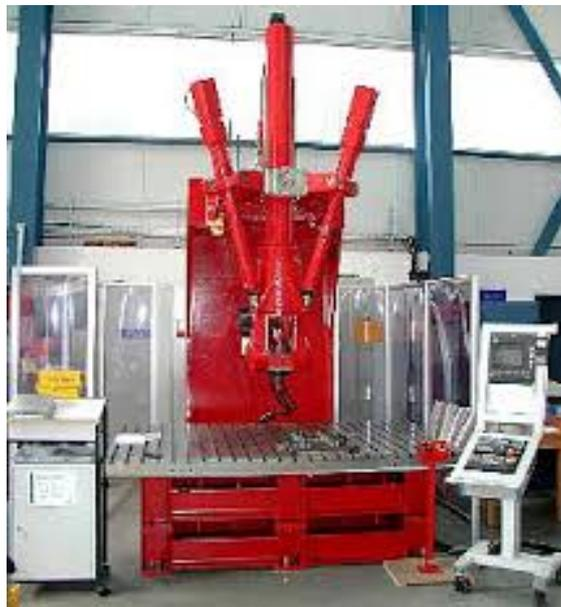
FIGURE 1.21 – Tricept TR805 utilise en FSW
