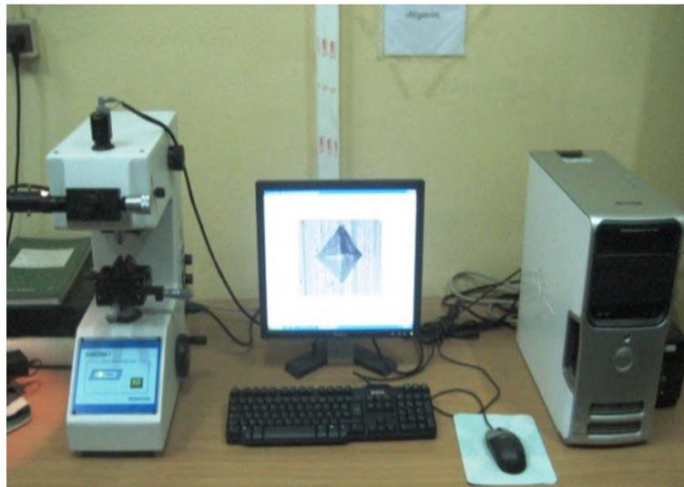
FIGURE 2.18 – Appareil de mesure de la microdureté.
