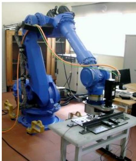
FIGURE 1.20 – Robot poly-articule pour le FSW
