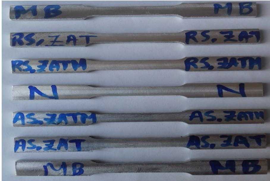
FIGURE 2.23 – Micro-éprouvettes pour les essais de traction.
