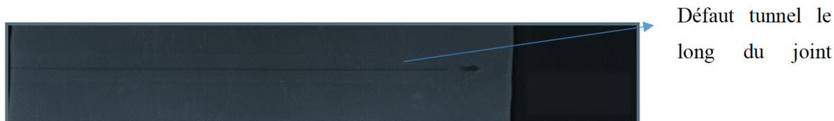
FIGURE 3.4 – Analyse radiographique par rayons X de l'échantillon
