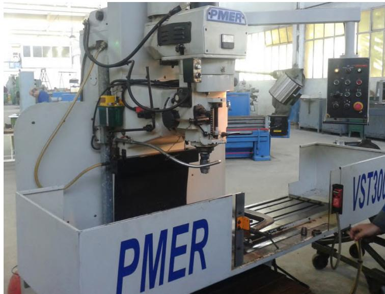
FIGURE 2.3 – Fraiseuse PMER utilisée pour le FSW.
