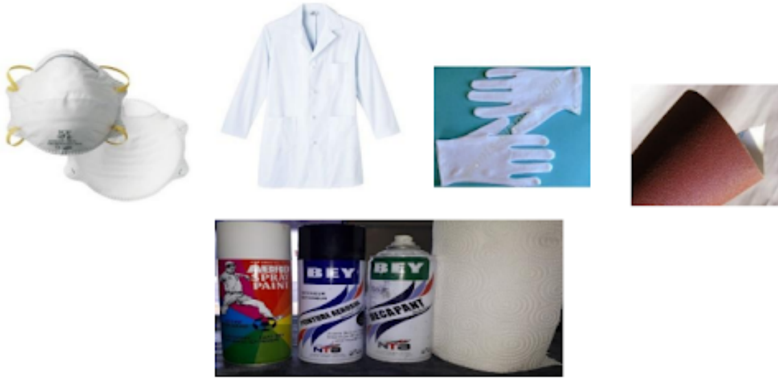
FIG. 3.10 : Outils nécessaires pour la réalisation du mouchetis
