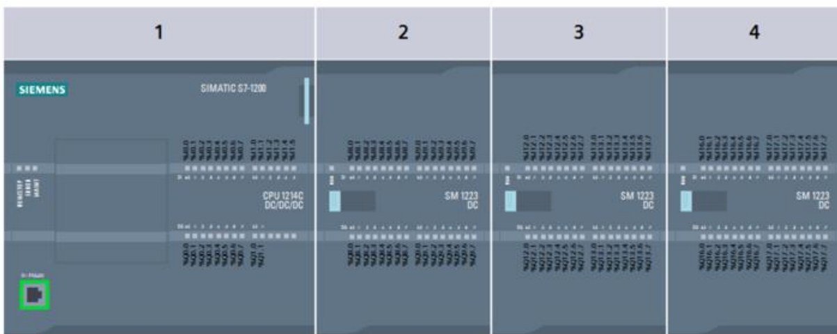
Figure IV. 7 : disposition de la CPU et des modules E/S sur le châssis.
