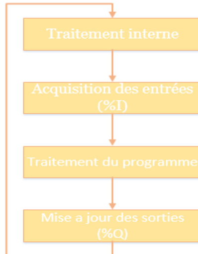
Figure I. 7 : Exécution d'un programme API.
