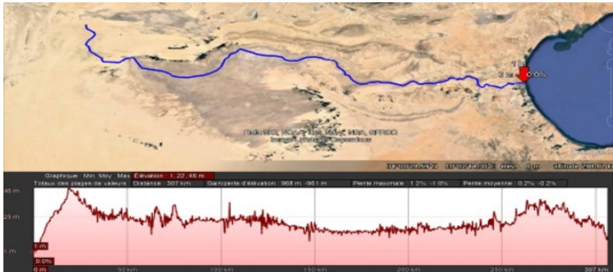
FIG. 2.4 : Le tracé du canal et son profil en long
