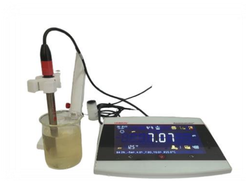
Figure 6. Mesure du pH
