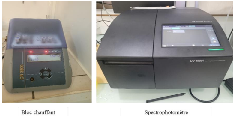
Figure 10. Matériels utilisés pour l'analyse de la DCO
