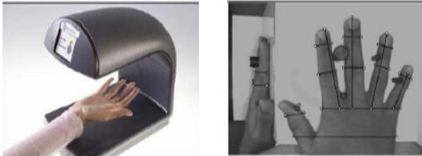
**Figure I.7.** Image de la géométrie de la main.
