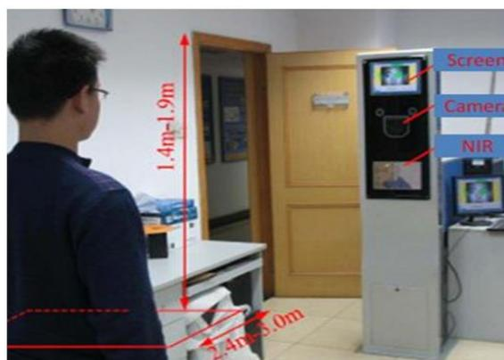
**Figure IV.1.** Capteur biométrique pour l'acquisition des images de *CASIA-Iris-Distance*.
