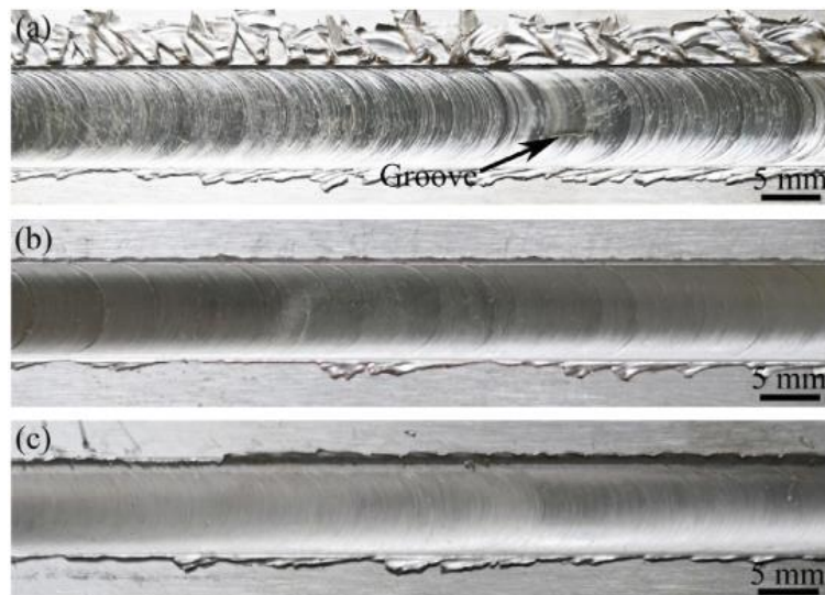
Figure I. 8 : État de surface de la soudure pour les paramètres (\omega, V) suivants ; (a) 1000-25, (b) 3000-75 et (c) 5000-125[58].
