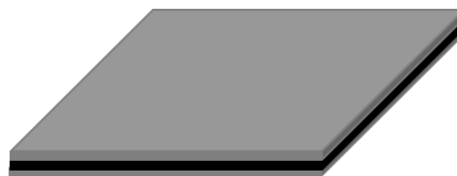
Figure 2. 7: Plaque sandwich avec un noyau en élastomère magnétorhéologique.
