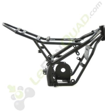
FIG. 1.1 : Cadre d'une moto électrique
