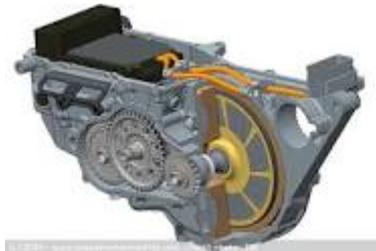
FIG. 1.2 : Moteur de la moto électrique
