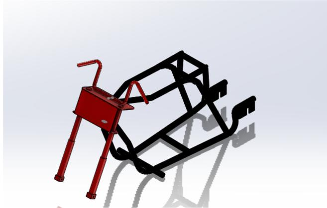
FIG. 3.46 : Le châssis, support de selle, amortisseurs et colonne de Direction.
