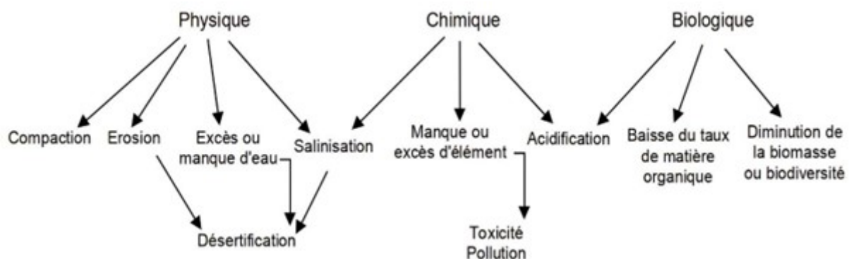
FIGURE 1.2 – Schéma illustrant les différents facteurs qui affectent la dégradation des sols [18]
