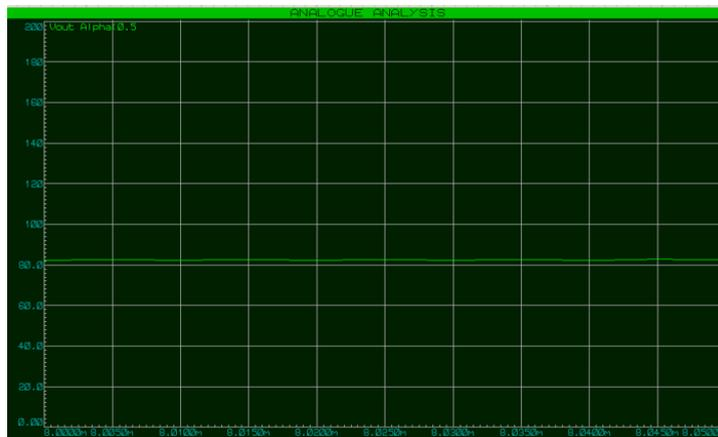
FIGURE 4.5 – Tension de sortie du SEPIC pour  $\alpha = 0.4$
