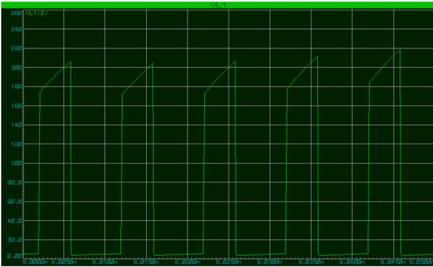
FIGURE 4.6 – La tension aux bornes de la bobine L1.
