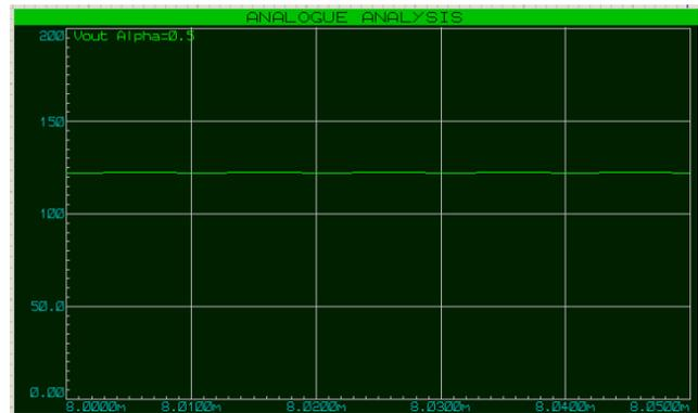
FIGURE 4.4 – Tension de sortie du SEPIC pour  $\alpha = 0.5$
