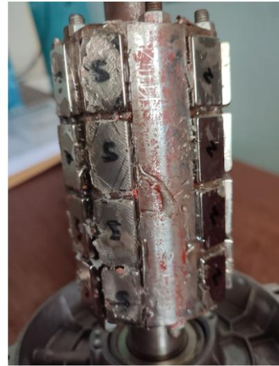
FIG. 2.5 : Intégration des Aimants sur la Surface du Rotor.
