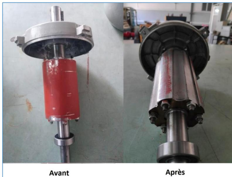
FIG. 2.4 : Le rotor avant et après usinage.
