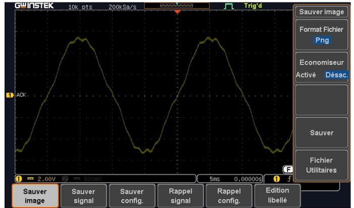
FIG. 5.10 : Courbe de tension essai en charge.
