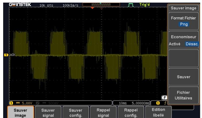
FIG. 5.21 : Tensions composées aux bornes de la charge  $U_{12}$ .
