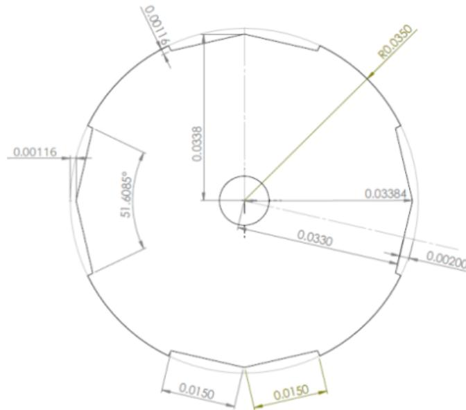
FIG. 2.3 : Usinage du rotor avec les aimants.
