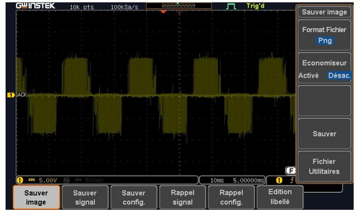
FIG. 5.26 : Tensions composées aux bornes de la charge  $U_{13}$ .
