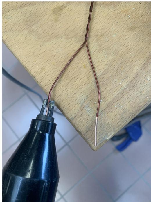
FIGURE 2.4 – Machine à dénuder "Abisofix"
