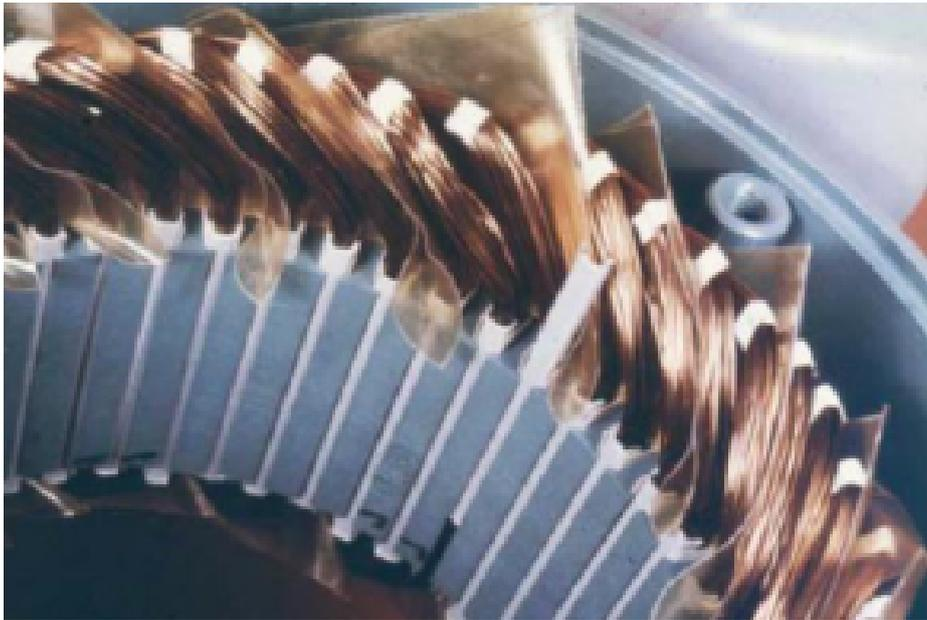
FIGURE 1.5 – l'isolation entre phases d'un bobinage distribué triphasé [39]
