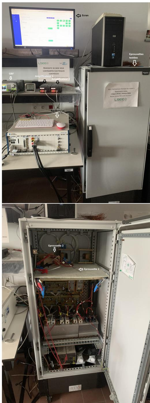
FIGURE 2.10 – Appareil de vieillissement électrique
