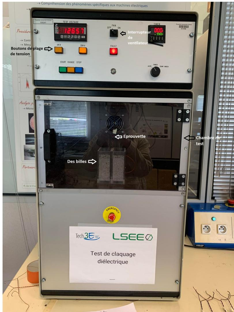
FIGURE 2.11 – Appareil "break down tester" de mesure de la tension de claquage
