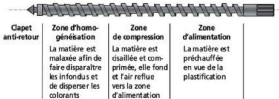
Fig. 1.6: Profil d'une vis de plastification.
